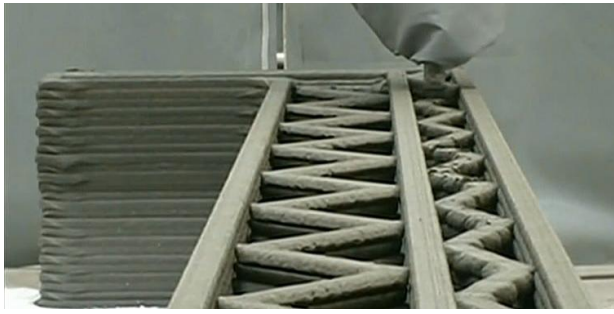
Рис. 2. 3D-друкування будівельних об'єктів:
