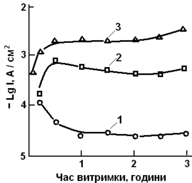
Рисунок 7.8 – Зміння в часі швидкості корозії у киплячій 65 %-ій \text{HNO}_3 зразків сталі 03X17H14M3 (кр. 1) і штучних карбїдів хрому (кр. 2) і хромомолібденового (кр. 3)
