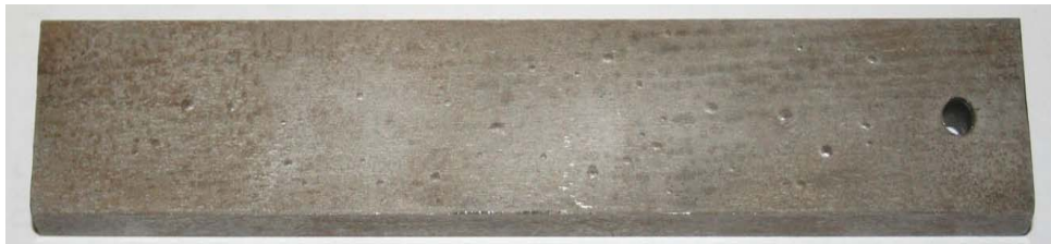
Рисунок 4.14 – Зовнішній вид зразка гарячекатаної труби \varnothing 89 \times 8 мм зі сталі 06X1-У після випробувань на водневе розтріскування
