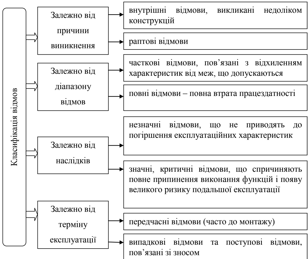
Рис. 2.9. Класифікація відмов будівельних конструкцій*
