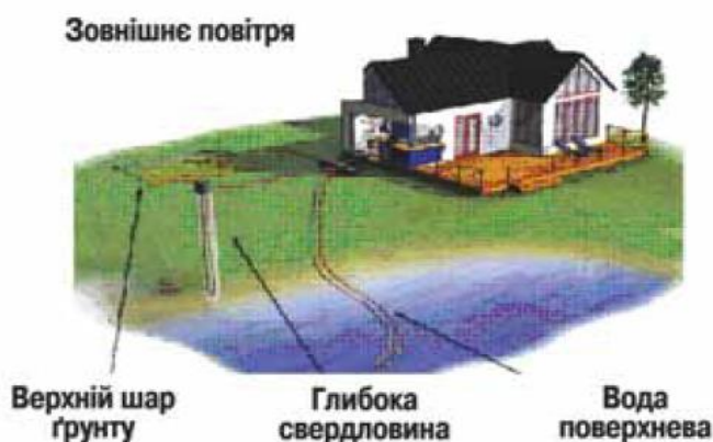
Рисунок 6.5 – Тепловий насос як джерело енергії
