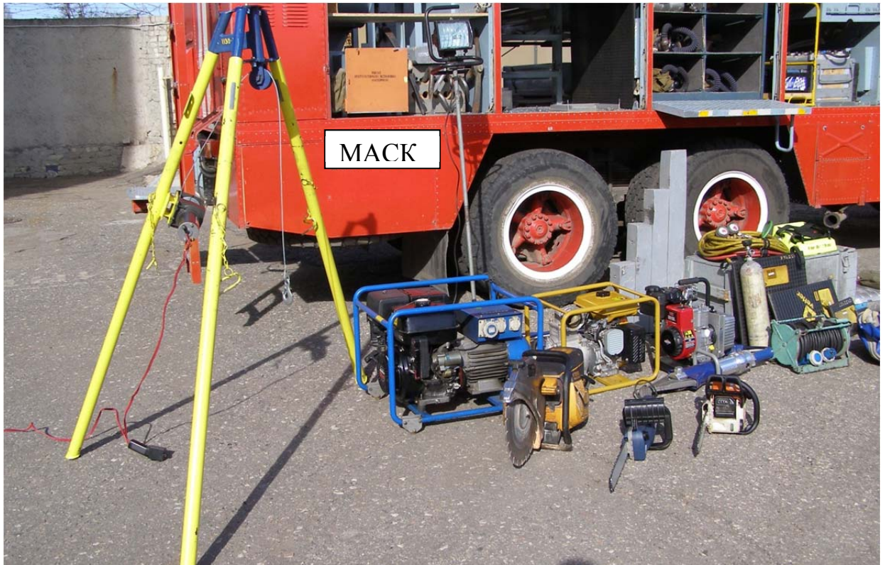
Рис. 2.3. Мобильный аварийно-спасательный комплекс (МАСК), оснащенный средствами малой механизации подъема (опускания) и перемещения грузов при выполнении АВР, СВР и АСР
