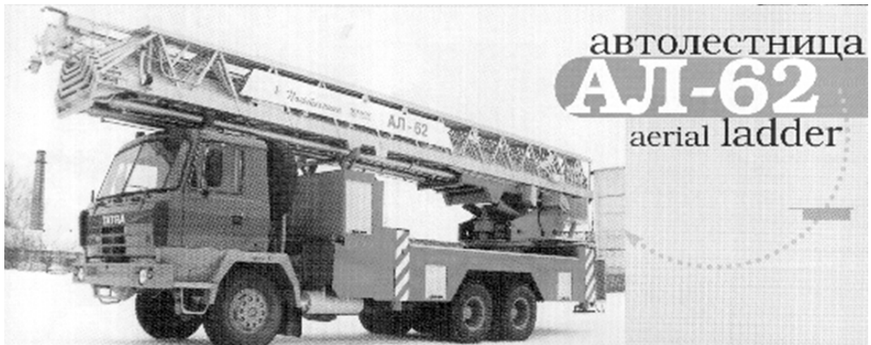
Рис. 1.19 – Автолестница АЛ-62 на шасси Татра-815 ; высота подъема 62м
