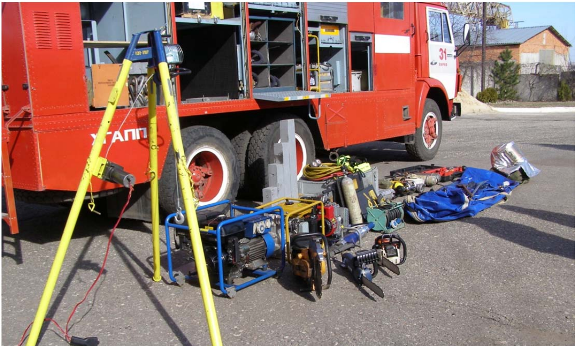
Рис. 1.25. Многофункциональный аварийно-спасательный комплекс АСК-МФ и комплект ручного и механизированного инструмента и оборудования с миникомплексами: МК1 (на заднем плане) и МК2 (на переднем)
