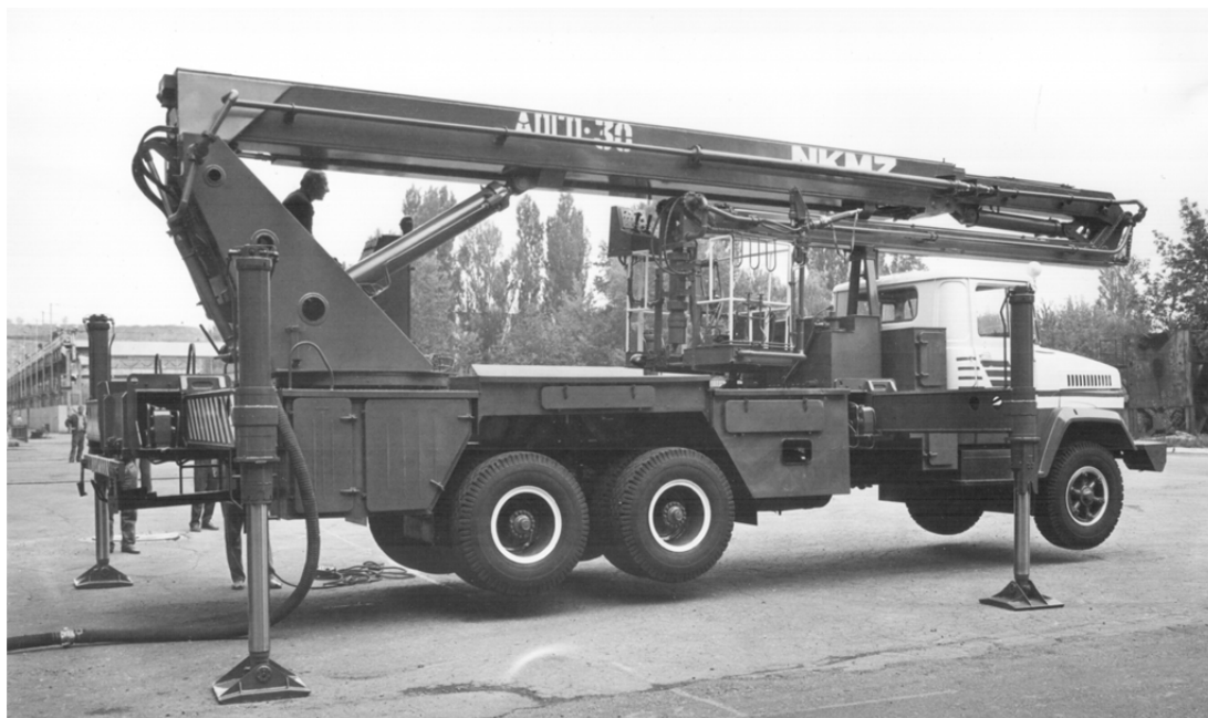
Рис. 4.6. Отечественный коленчатый автоподъемник гидравлический пожарный (АПП-30) с высотой развертывания стрелы до 30 м
