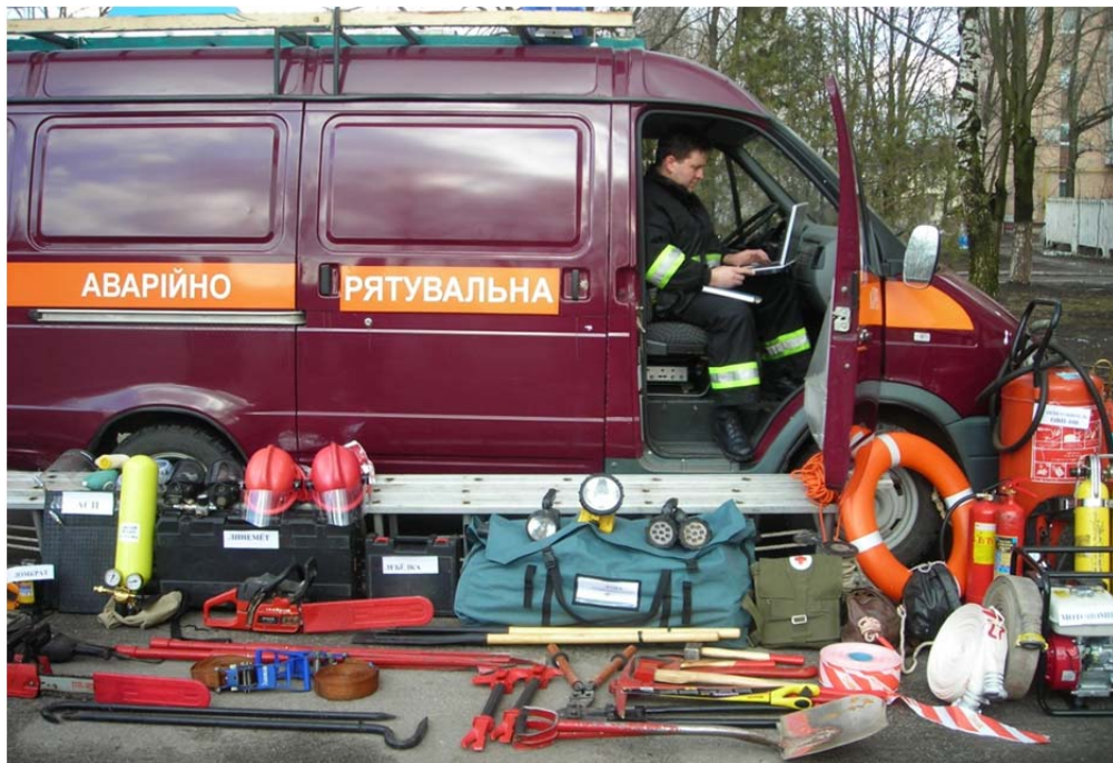
Рис. 2.4. Предложенный аварийно-спасательный комплекс автомобиля первой помощи с комплектом ручного и механизированного инструмента и оборудования
