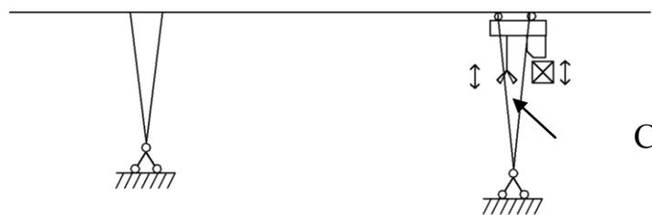
Рис. 4.1. Схема установки грейферной тележки крана и место установки сейсмометра
