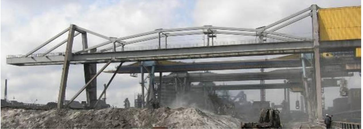
Рис. 1.4. Мостовой кран-перегрузатель шпренгельно-балочной конструкции с шарнирной и жесткой опорами
