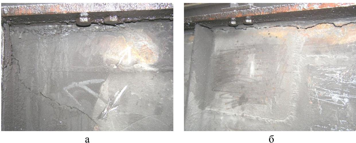
Рис. 2.2. Трещины в ездовой балке перегружателя трубчато-балочного типа:
