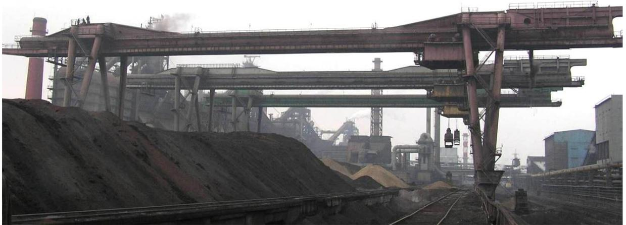
Рис. 1.3. Мостовой кран-перегрузатель трубчато-балочной конструкции с опорами равной жесткости
