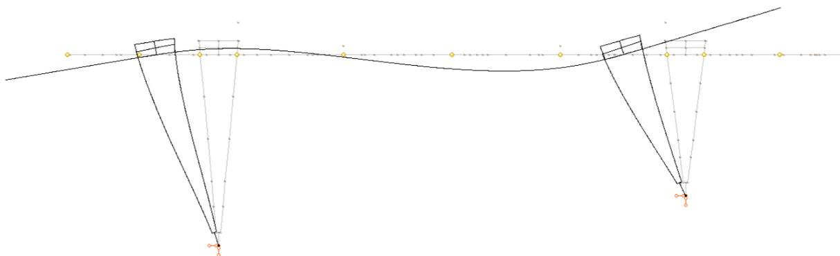
Рис. 2.7. Схема деформации крана в его вертикальной плоскости при движении тележки
