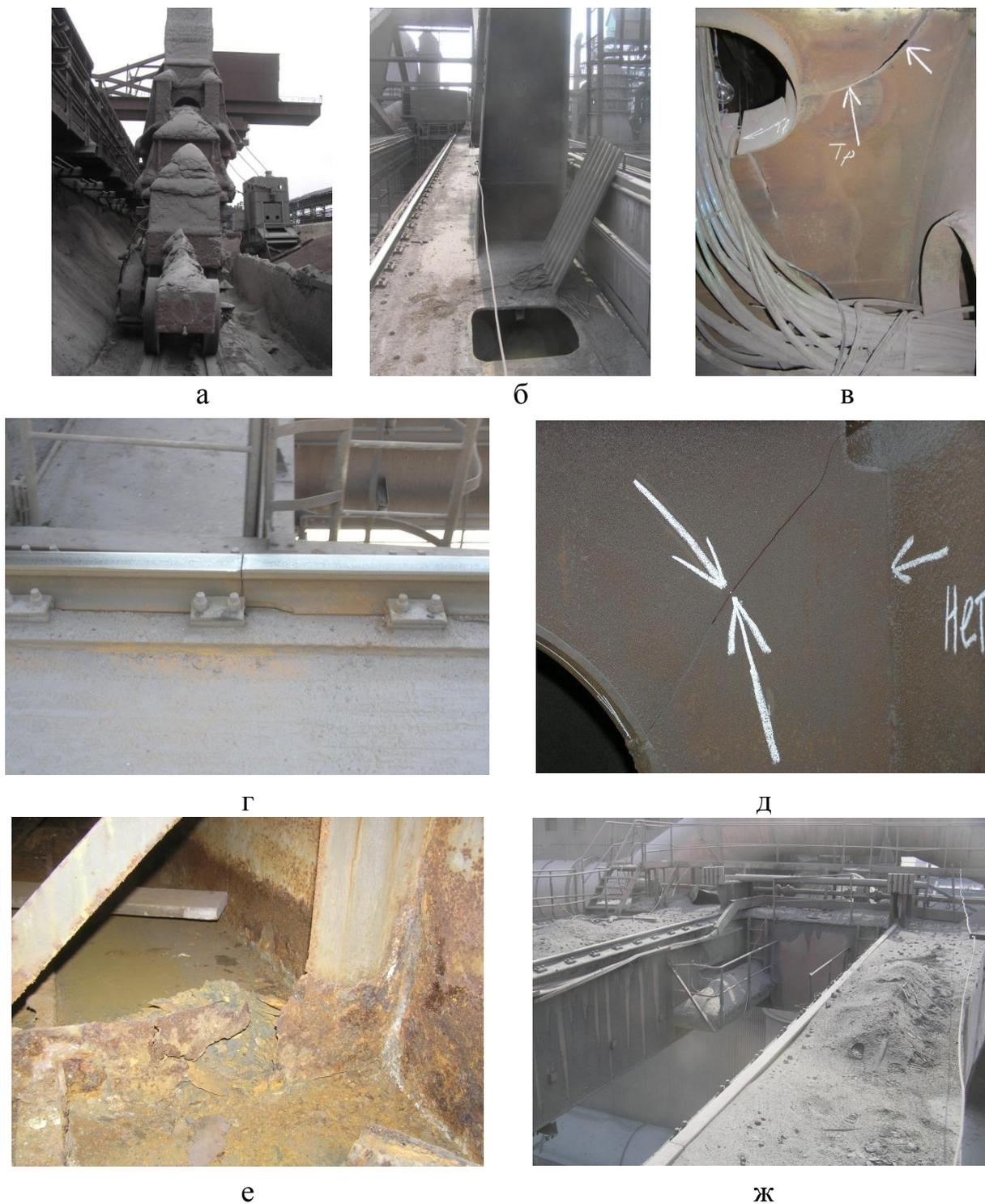
Рис. 2.1. Дефекты и повреждения металлоконструкций перегружателя:
