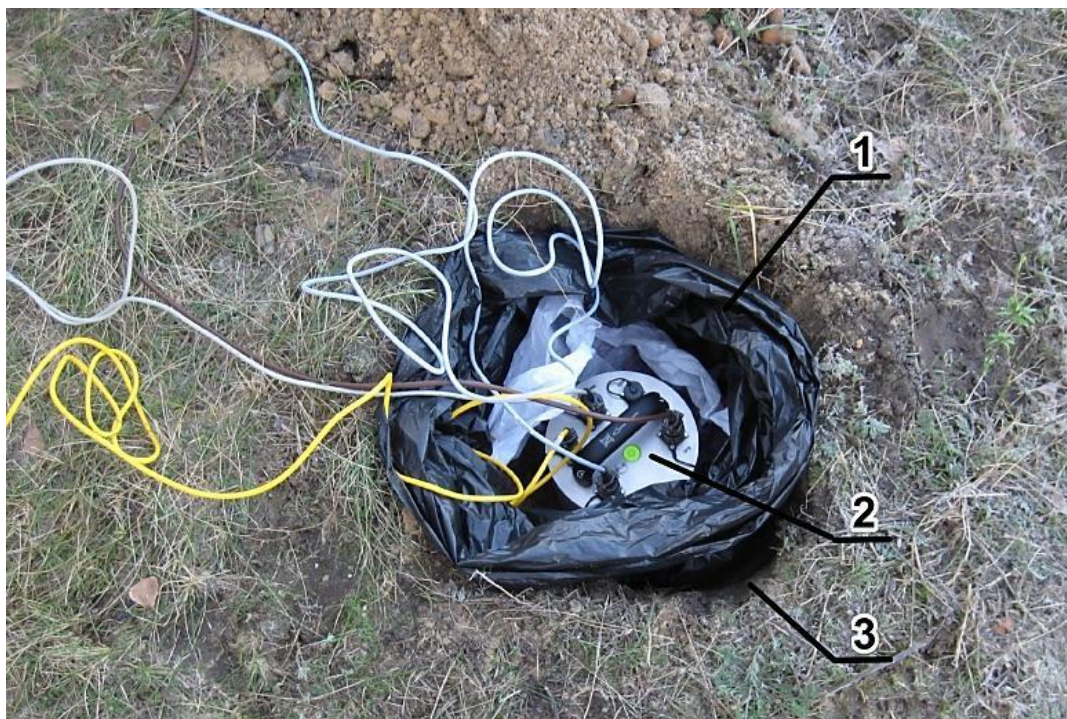
Рис. 3.6. Встановлення сейсмометра GURALP в польових умовах: 1 – гідроізоляційний матеріал (щільна водонепроникна поліетиленова упаковка), 2 – сейсмологічний прилад, 3 – поглиблення.
