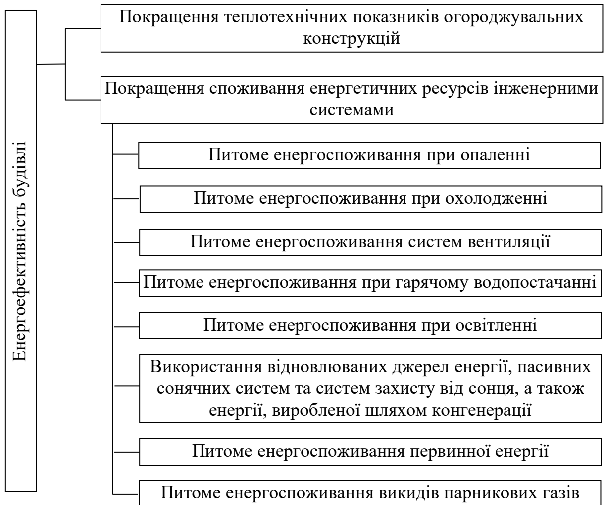
Рисунок 4.5 – Складові фактора енергоефективності будівлі
