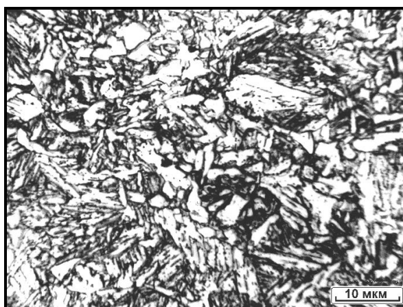
Рис. 3.6. Продукты распада аустенита при закалке от температур верхней части МКИ (860°C) для стали 10Г2ФБ.
