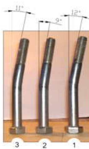
Рисунок 4.30 – Деформування болтів в результаті згину під дією навантаження
