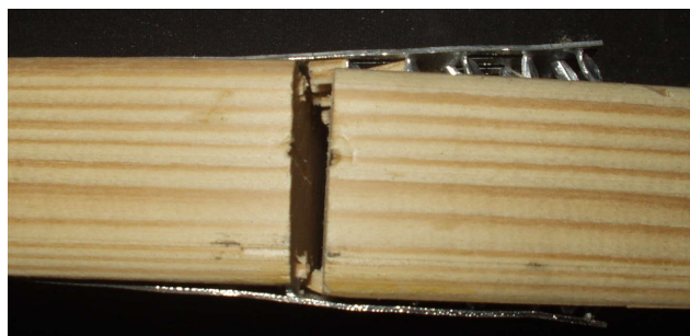
Рисунок 4.40 – Характер руйнування з'єднань дерев'яних елементів на металевих зубчастих пластинах при випробуваннях на згин
