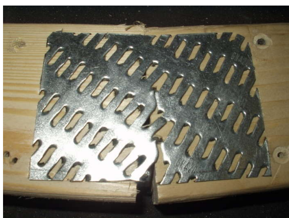
Рисунок В.21 – Характер руйнування зразків серії В30
