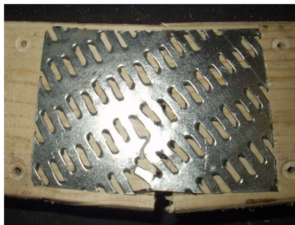
Рисунок В.21 – Характер руйнування зразків серії В30
