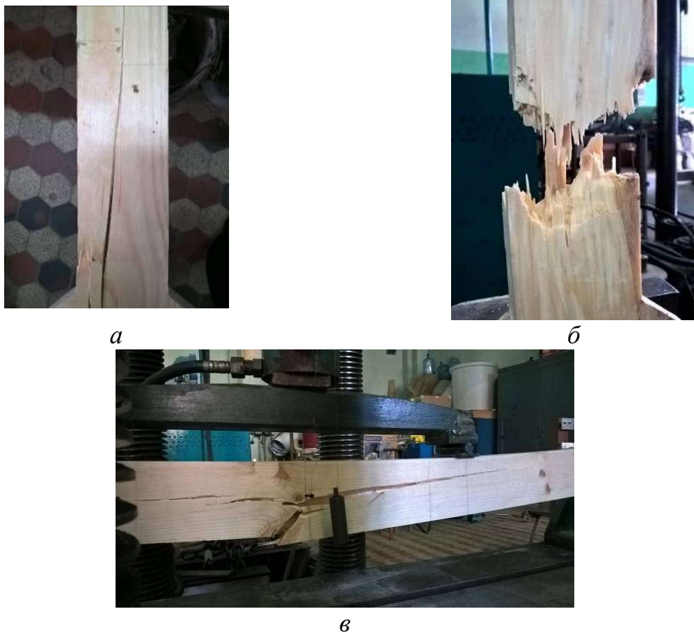
Рисунок 4.2 – Характер руйнування зразків при випробуванні на розтяг: а – руйнування в зоні захвату; б – руйнування по волокнам; в – балок при випробуванні на згин
