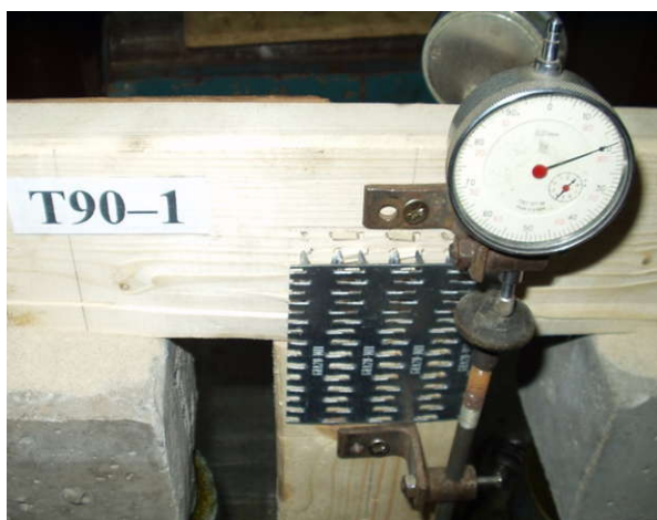
Рисунок В.15 – Характер руйнування зразків серії Т90
