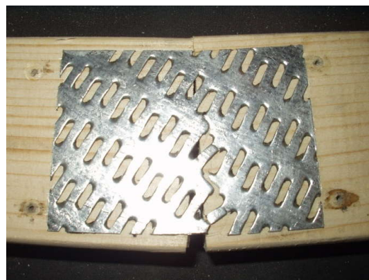
Рисунок В.22 – Характер руйнування зразків серії В60
