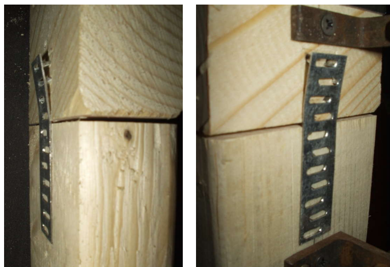
Рисунок В.18 – Характер руйнування зразків серії TR60
