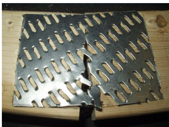
Рисунок В.22 – Характер руйнування зразків серії В60
