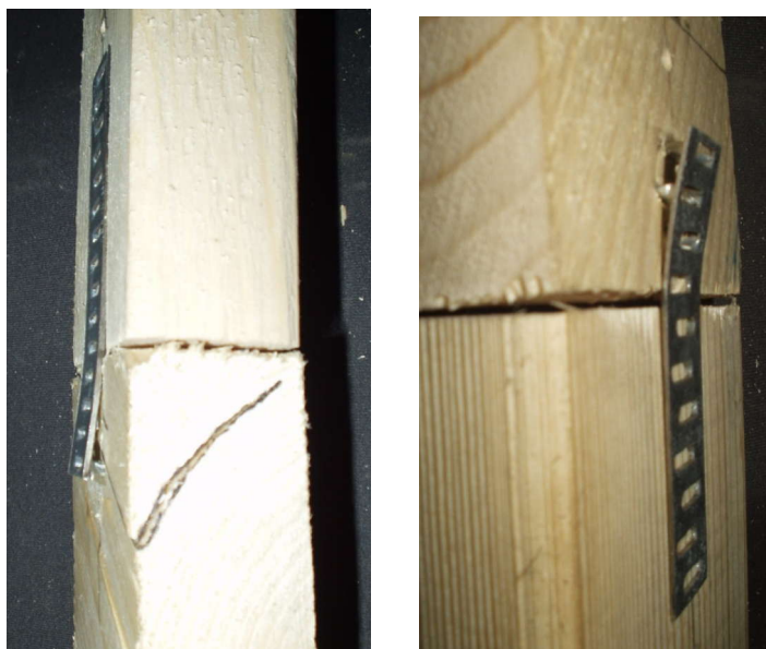
Рисунок В.17 – Характер руйнування зразків серії TR30
