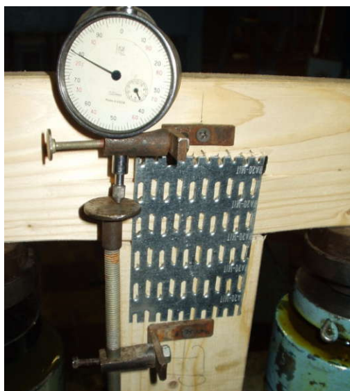
Рисунок В.16 – Характер руйнування зразків серії TP0
