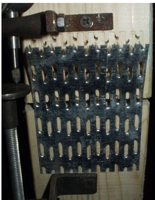
Рисунок В.12 – Характер руйнування зразків серії Т0
