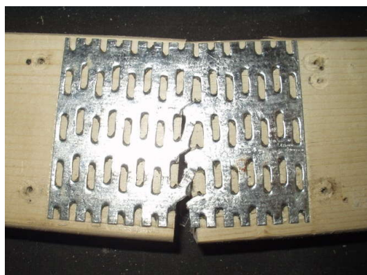
Рисунок В.23 – Характер руйнування зразків серії В90
