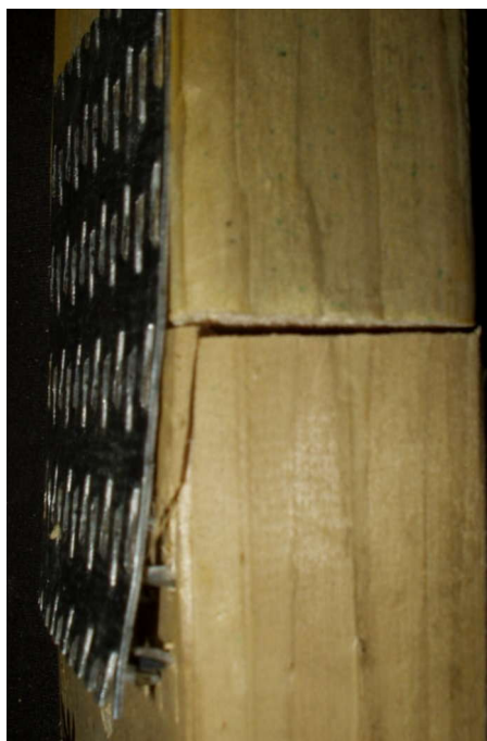
Рисунок В.12 – Характер руйнування зразків серії Т0
