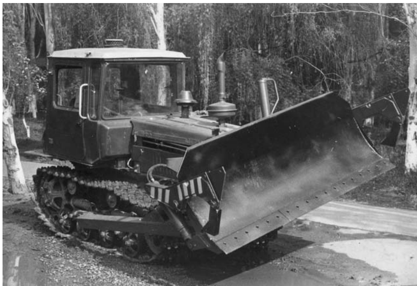
Рис. 8. Рабочее оборудование многоцелевого назначения на базе бульдозера ДЗ-162-04
