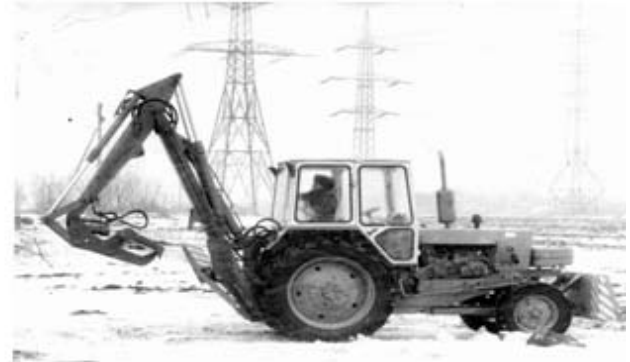
Рис. 24. Рабочий орган в виде двухпальцевого схвата на базе гидравлического экскаватора ЭО-2621В-3
