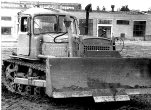
Рис. 5. Общий вид бульдозера ДЗ-42 (Д-606) с выступающим средним ножом и газовой смазкой поверхности скольжения
