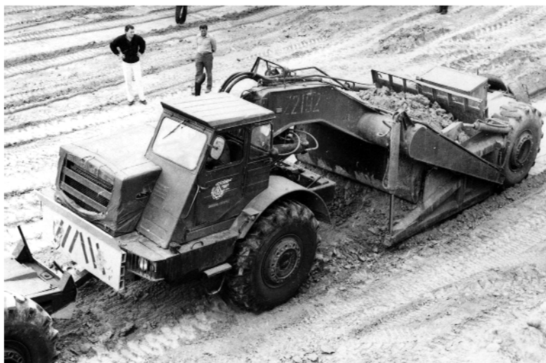
Рис. 11. Общий вид скрепера Д-357 П, снабженного цепно-толкающим устройством
