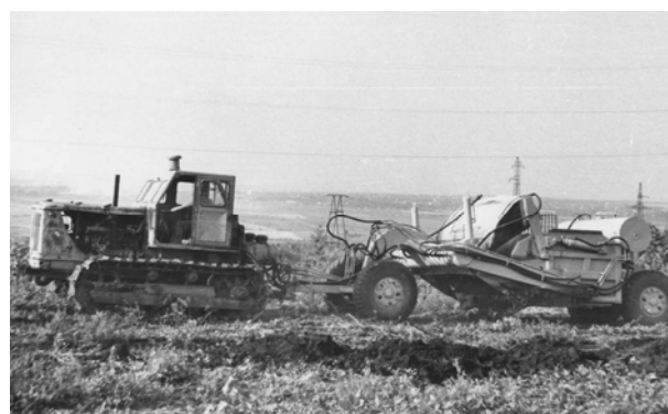
Рис. 13. Общий вид скрепера Д3-20 с газовой смазкой поверхности скольжения и выступающим средним ножом
