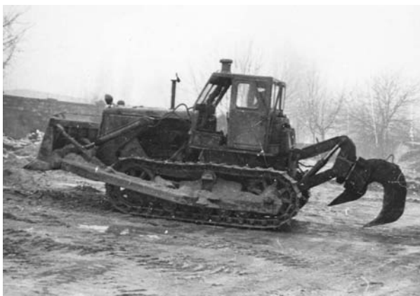
Рис. 15. Схемы рыхлительного рабочего оборудования к тракторам: а – общий вид гусеничного трактора с рыхлителем конструкции ДИСИ; б – общий вид рыхлителя с траекторно-последовательным расположением зубьев; в, г – наконечники соответственно без и с ребрами жесткости; д, е – асимметричные наконечники соответственно с удлиненными ребрами жесткости; ж, з – асимметричные с ребрами жесткости и с боковыми уширителями
