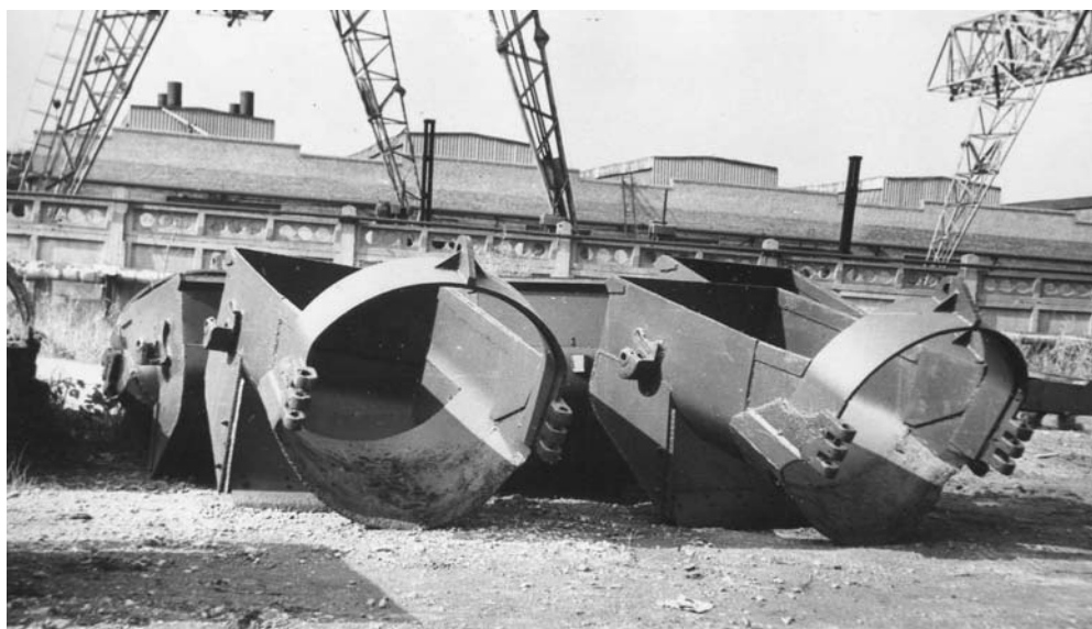
Рис. 20. Ковши драглайнов с двухножевой системой копания
