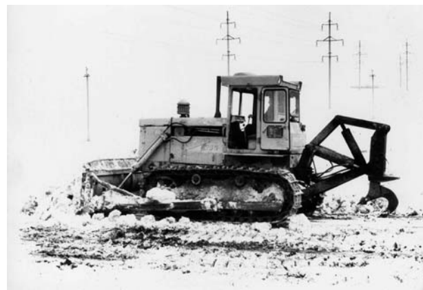
Рис. 15. Схемы рыхлительного рабочего оборудования к тракторам: а – общий вид гусеничного трактора с рыхлителем конструкции ДИСИ; б – общий вид рыхлителя с траекторно-последовательным расположением зубьев; в, г – наконечники соответственно без и с ребрами жесткости; д, е – асимметричные наконечники соответственно с удлиненными ребрами жесткости; ж, з – асимметричные с ребрами жесткости и с боковыми уширителями
