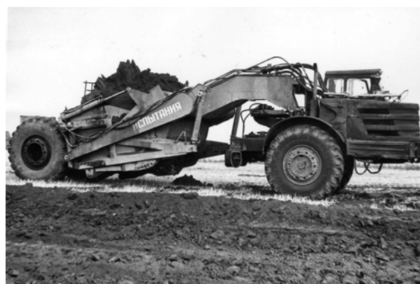
Рис. 14. Общий вид скрепера Д-357П с двухножевой системой копания и управляемым задним ножом
