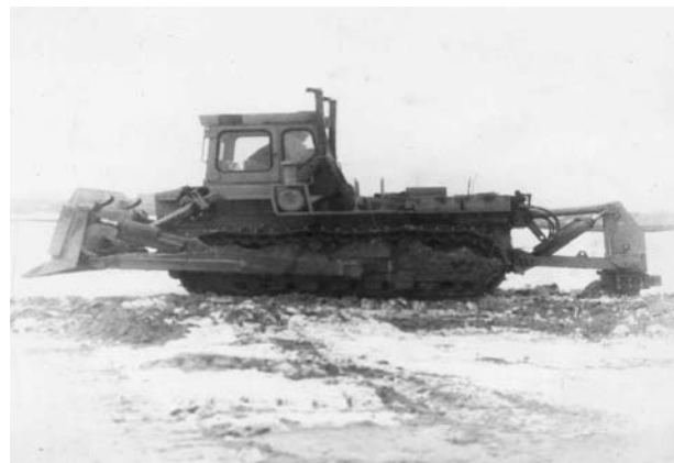
Рис. 16. Параметрический ряд рыхлителей с траекторно-последовательным расположением рыхлящих зубьев на тракторах: а - Т-100, б - Т-130, в - ДЭТ-250, г - Т-330
