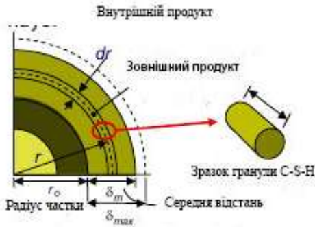
Рис. 2. Модель частинки цементу, що гідратується
