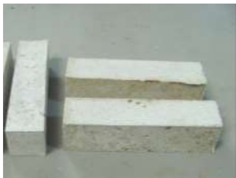
Рис. 1. Загальний вигляд досліджуваних зразків: а – балочки, б – «вісімки».
