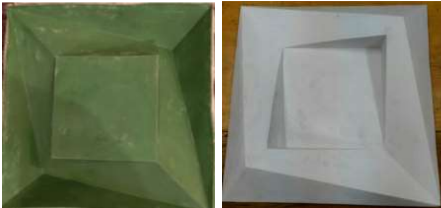
Рис. 10. Форма та гіпсова 3D панель
