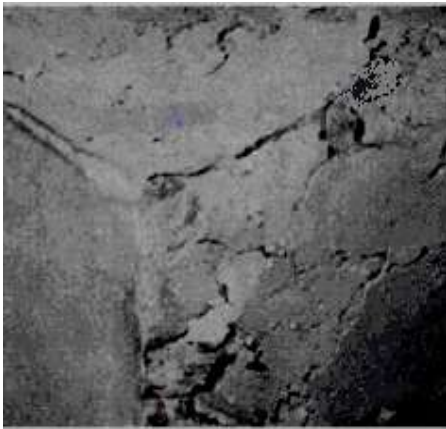
Рис. 2. Фотография фибробетона после испытаний на сжатие
