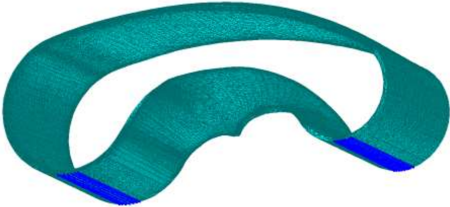
Рис. 12. Закрепления конечно-элементной модели.
