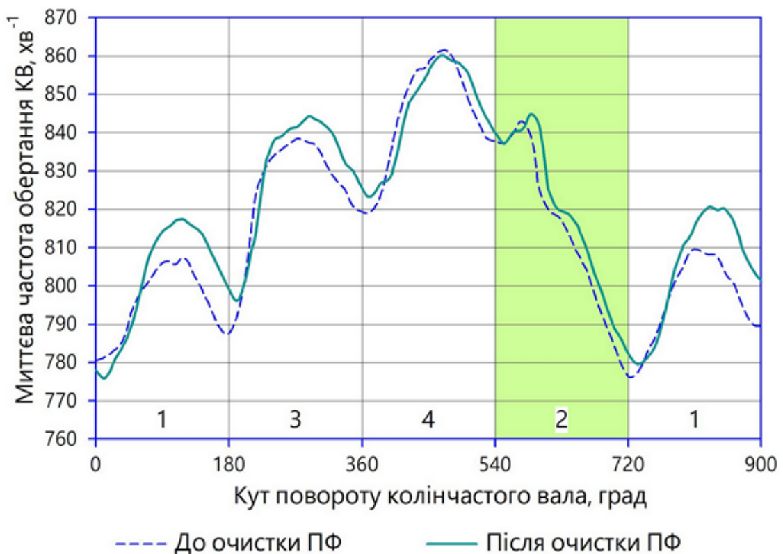
Рис. 2.22. Графік зміни миттєвої частоти обертання КВ двигуна Z22SE до та після ультразвукової очистки форсунок з відключеним 2-им циліндром
