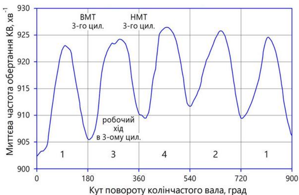
Рис. 2.15. Графік зміни миттєвої частоти обертання КВ двигуна F16D3
