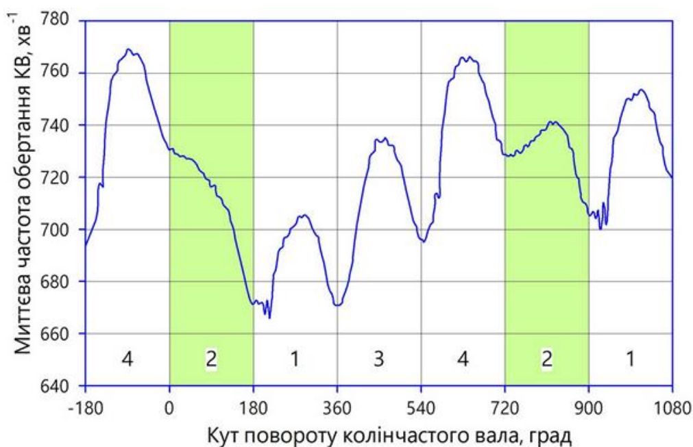
Рис. 2.18. Графік зміни миттєвої частоти обертання КВ двигуна Z22SE з несправністю паливної форсунки 2-го циліндра на режимі холостого ходу
