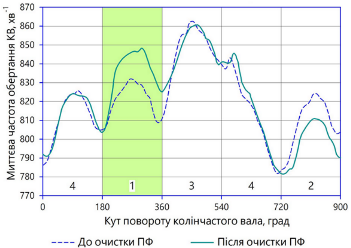
Рис. 2.23. Графік зміни миттєвої частоти обертання КВ двигуна Z22SE до та після ультразвукової очистки форсунок з відключеним 3-ім циліндром
