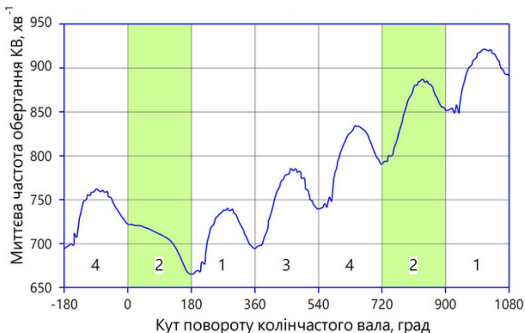
Рис. 2.19. Графік зміни миттєвої частоти обертання КВ двигуна Z22SE з несправністю паливної форсунки 2-го циліндра на режимі вільного прискорення
