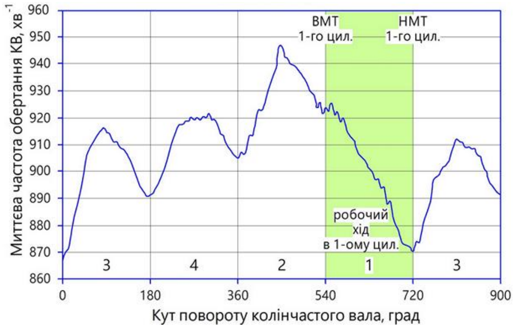
Рис. 2.16. Графік зміни миттєвої частоти обертання КВ двигуна F16D3 з вимкнутим 1-им циліндром
