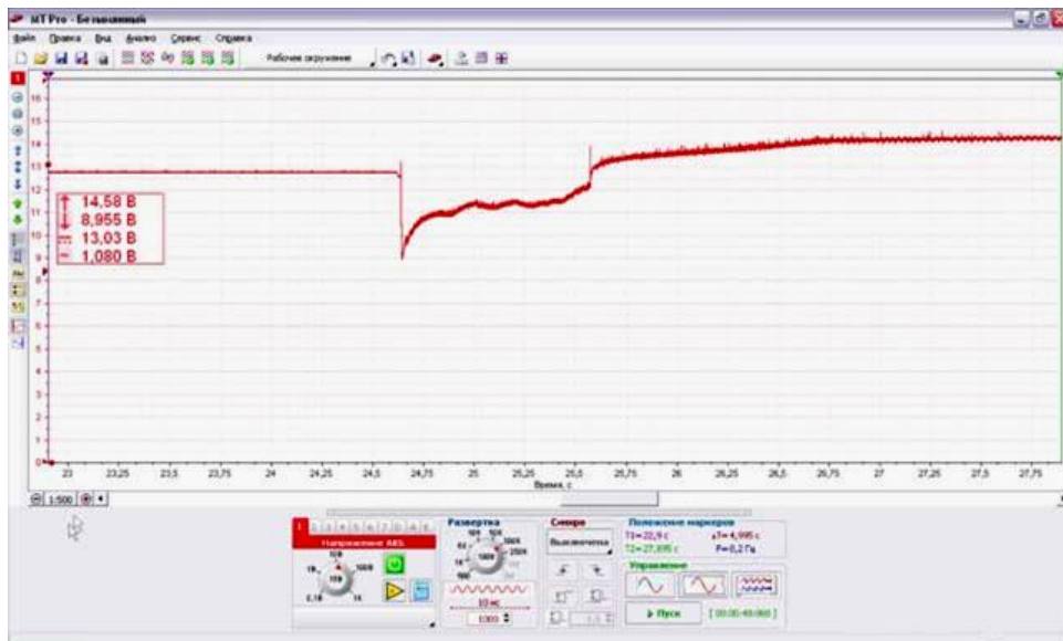
Рис. 2.7. Запис осцилограми напруги бортової мережі за допомогою мотор-тестера (пуск двигуна і робота на режимі холостого ходу)
