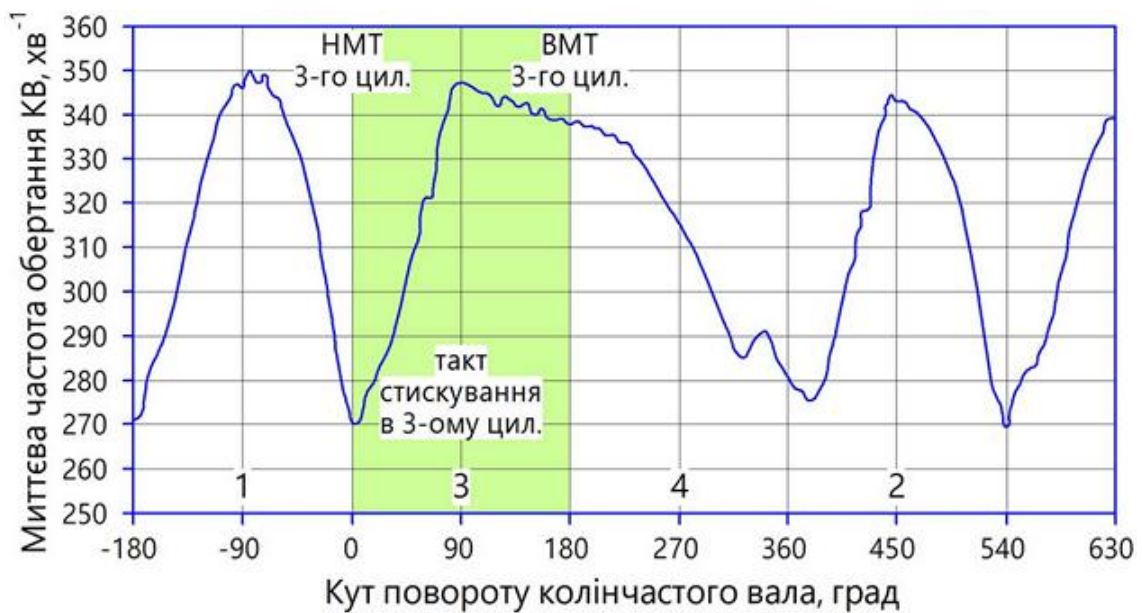
Рис. 2.14. Графік зміни миттєвої частоти обертання КВ двигуна BMW M43B18 з вивернутою свічкою запалювання 3-го циліндра
