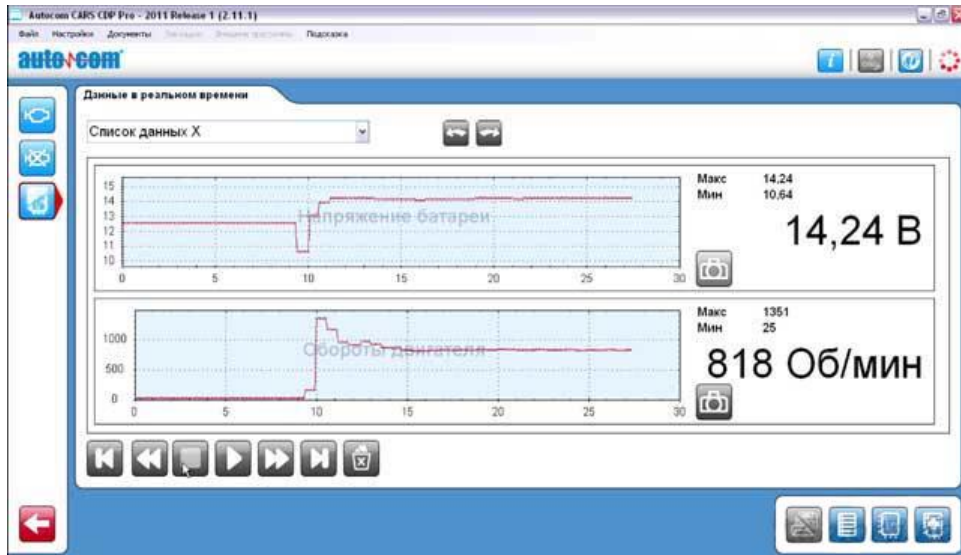
Рис. 2.6. Запис осцилограми напруги бортової мережі за допомогою сканера (пуск двигуна і робота на режимі холостого ходу)
