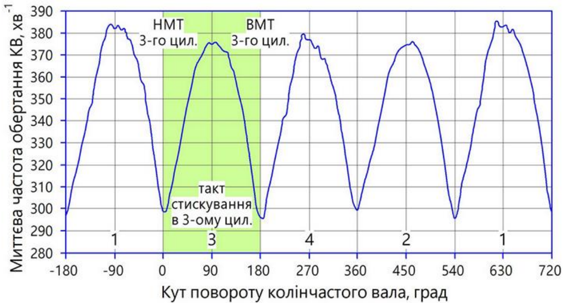
Рис. 2.13. Графік зміни миттєвої частоти обертання КВ двигуна BMW M43B18
