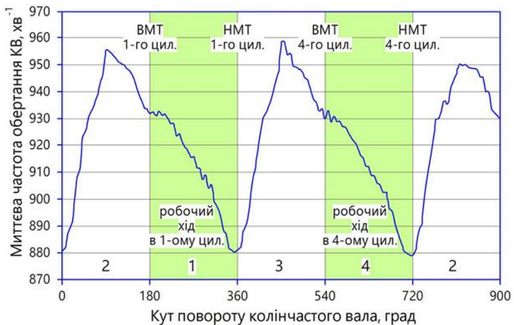
Рис. 2.17. Графік зміни миттєвої частоти обертання КВ двигуна F16D3 з вимкнутими 1-им і 4-им циліндрами
