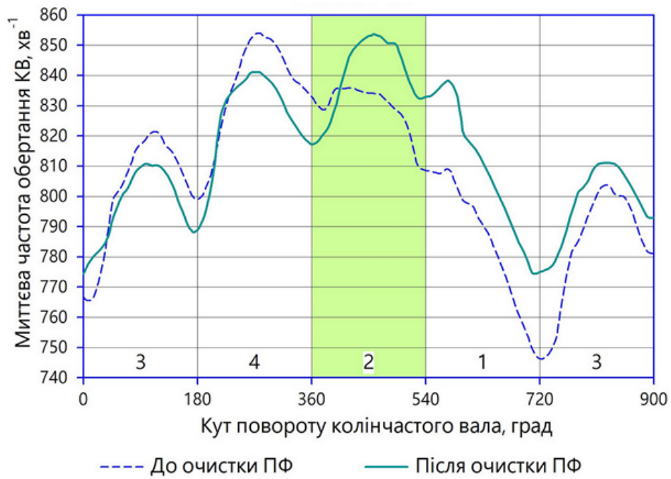
Рис. 2.21. Графік зміни миттєвої частоти обертання КВ двигуна Z22SE до та після ультразвукової очистки форсунок з відключеним 1-им циліндром
