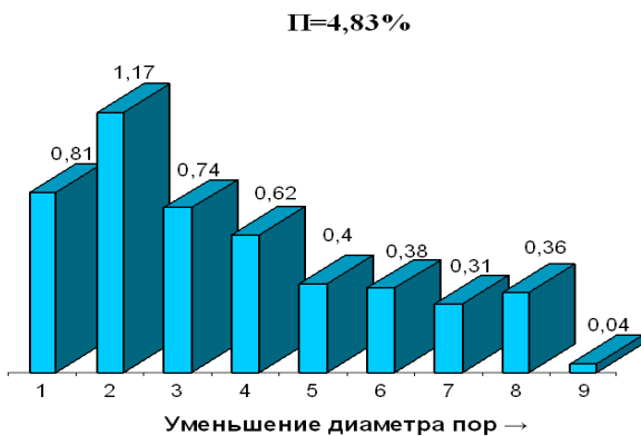
Рис. 5. Диаграмма пористости образцов: стеклофибробетон, приготовленный в гравитационном смесителе с уплотнением по традиционной технологии
