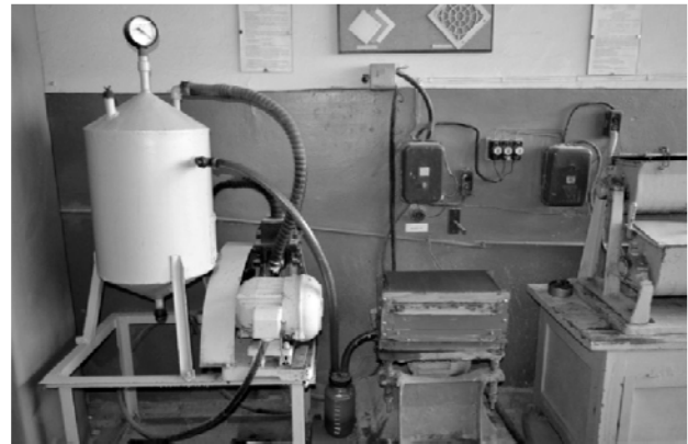
Рис. 2. Вакуумстанция для формирования золобетонных стеновых блоков
