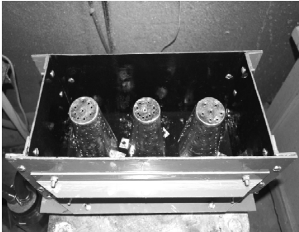
Рис. 1. Форма для формирования стеновых блоков методом виброввакуумирования
