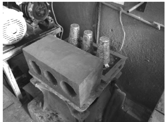
Рис. 3. Немедленная распалубка свежесформованных виброввакуумированием золобетонных стеновых блоков
