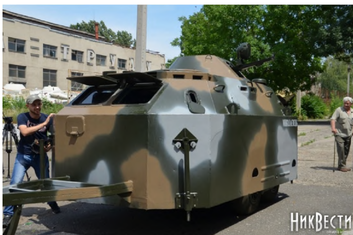
Рис. 5.5. Експериментальний пересувний блок - пост для захисту від вогневого ураження виготовлений Миколаївським бронетанковим ремонтним заводом.
