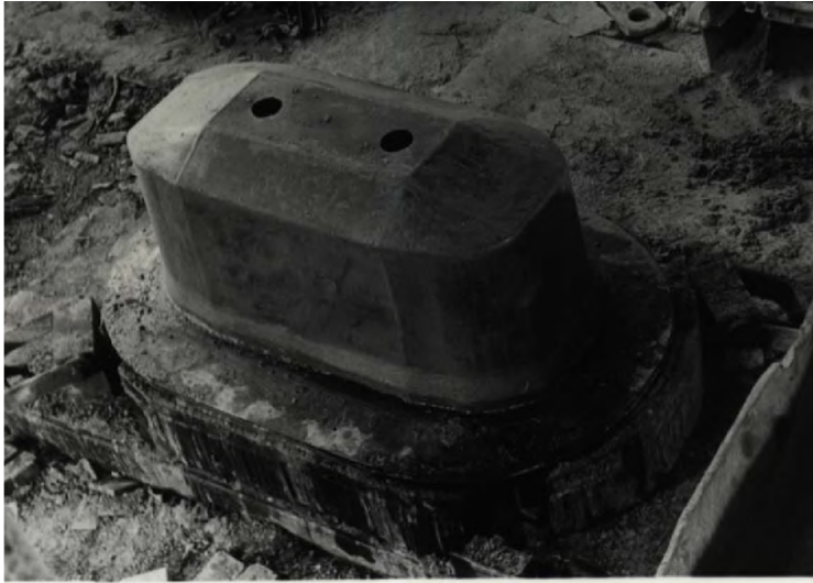
Рис. 2.9. Установка для виготовлення футерування прибуткових надставок з жаростійкого бетону.
