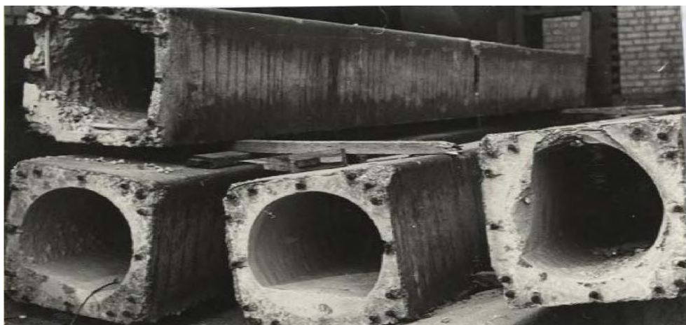
Рис. 2.18. Центрифуговані квадратні порожнисті стійки: а) загальний вигляд; б) процес випробування.
