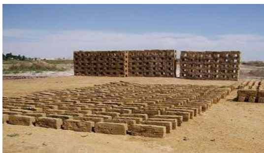
Рис. 4. 10. Сушіння саману (штабелями та врозкладку)
