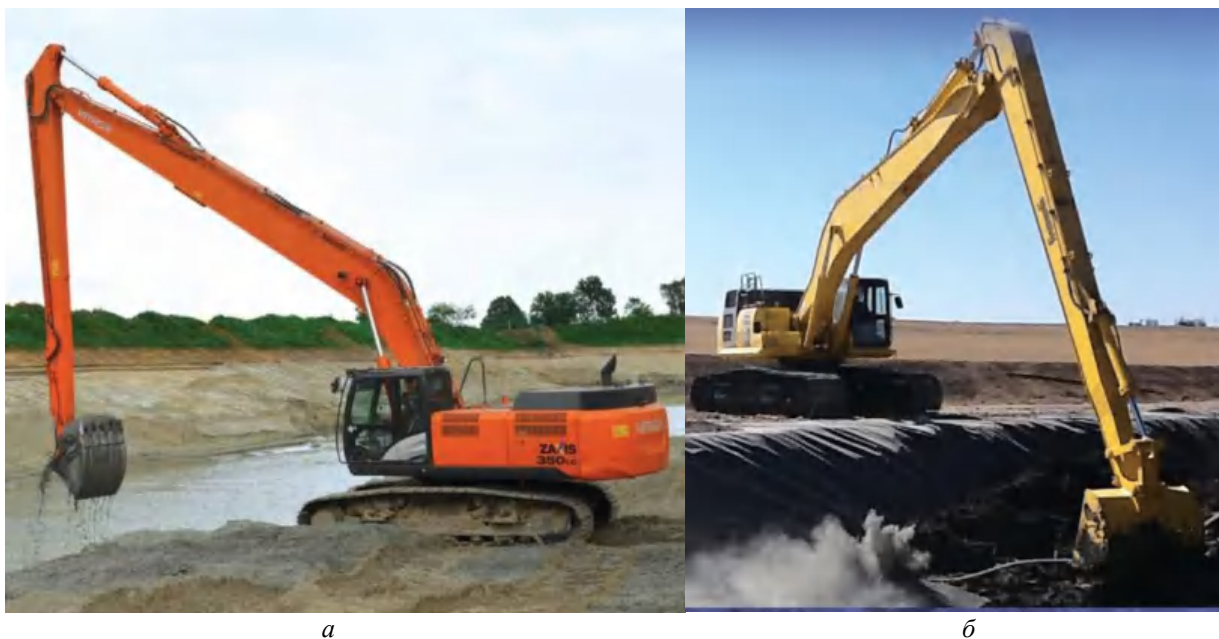
Рис. 3. Екскаватори зі збільшеним РО при виконанні робіт: а – Hitachi ZX 250LC при роботі на розчистці каналу; б – Komatsu PC 240LC-10
