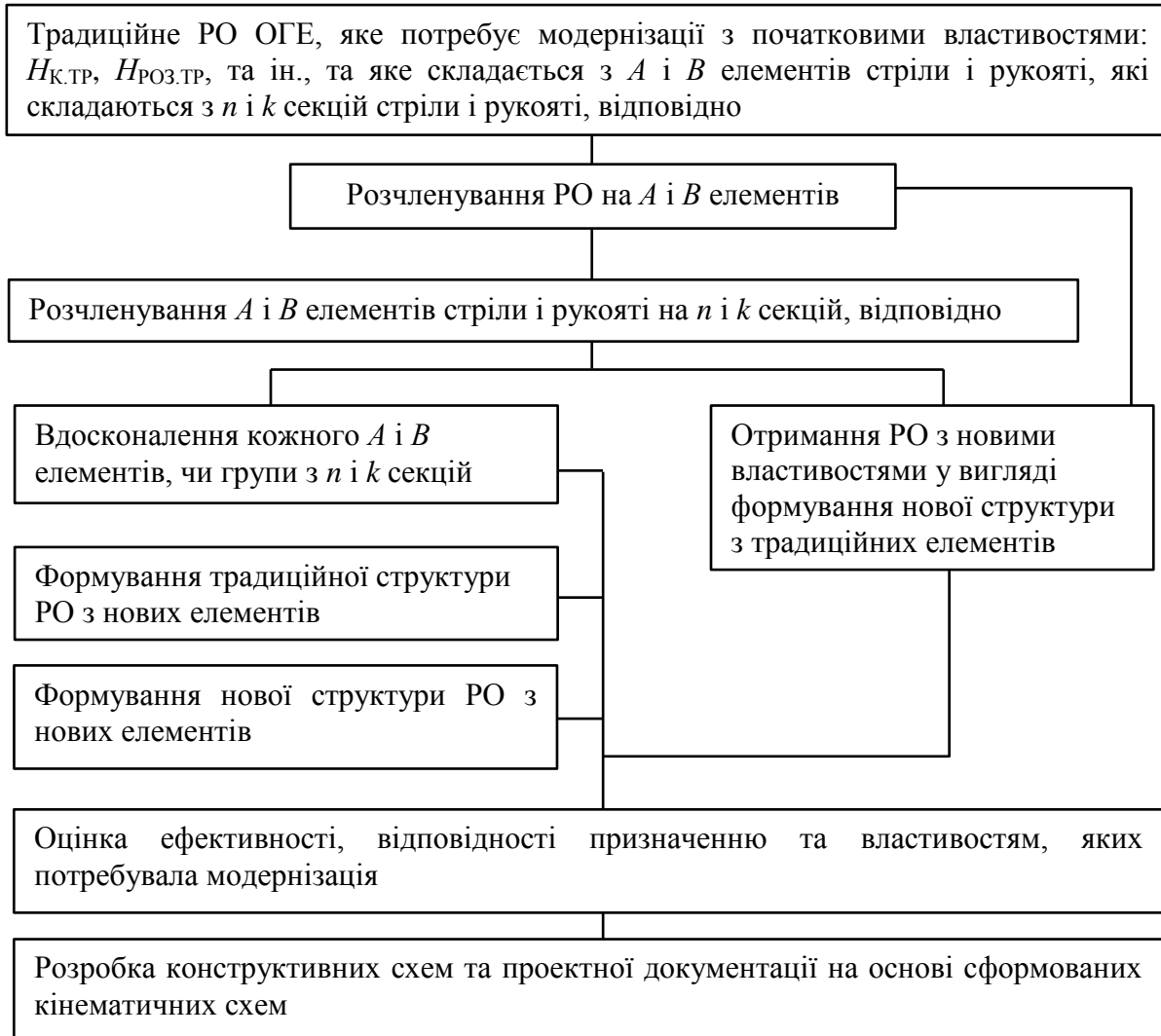
Рис. 1. Схема формування нового РО ОґЕ методом структурного синтезу.
