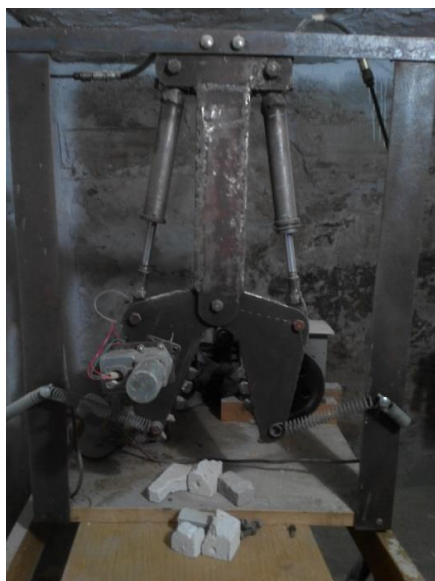
Рис. 3 Гидрожницы с эксцентриковым интенсификатором/ Hydraulic shears with an eccentric mechanism
