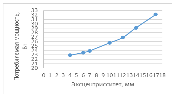
Рис. 7 Изменение потребляемой энергии в зависимости от эксцентриситета/ Changes in energy consumption depending on the eccentricity
