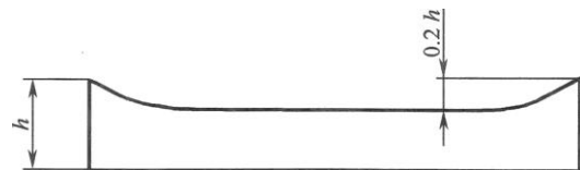
Рис 8. Форма лопаті, що має виріз в середній частині на величину 0,2h від її висоти h / The shape of the blade that has a notch in the middle part of the value of 0,2h from its height h
