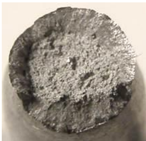
Рис.1. Характерный внешний вид разрывных образцов из сплава VT25У при 20 °С в исходном структурном состоянии/ Typical appearance of VT25U alloy tensile specimens at 20 °С in initial structure condition
