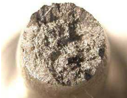
Рис.2. Характерный внешний вид разрывных образцов из сплава VT25У при 20 °С в СМК состоянии/ Typical appearance of VT25U alloy tensile specimens at 20 °С in submicrocrystalline condition
