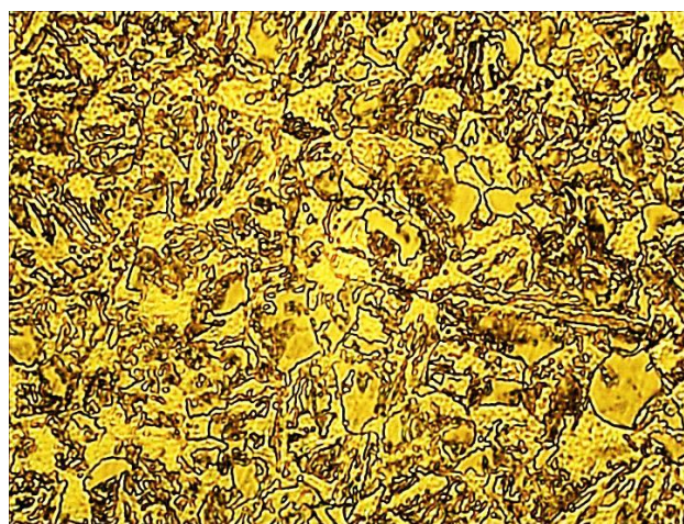
Рис. 2. Микроструктура стали 25ХГНМА после нагрева 900 °C и охлаждения со скоростью 5,3 °C/c / Microstructure of the steel 25HGMA after heating 900 °C and cooling with rate 5,3 °C/sec
