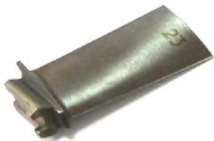
Рис. 1 - Общий вид лопатки компрессора высокого давления. / General view of high pressure compressor blade
