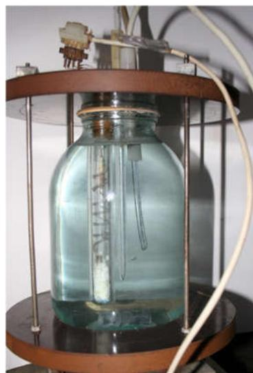
*Рис.3 Установка для проведения испытаний в сероводородсодержащих средах/Installation for tests in hydrogen sulphide environments*
