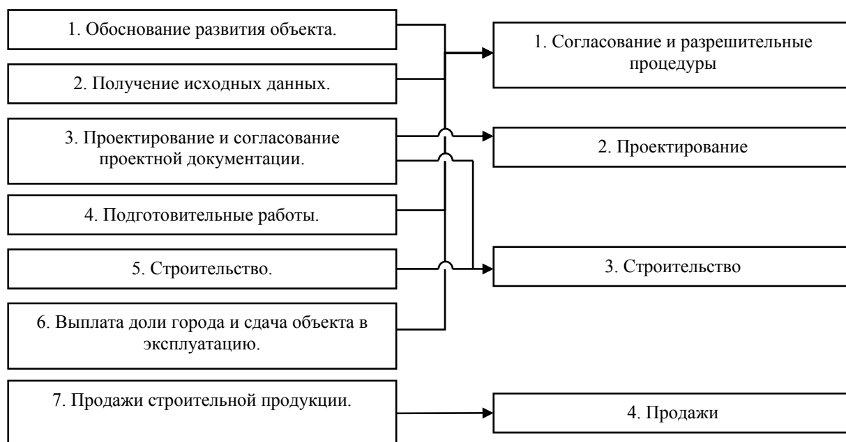
Рис. 1. Общая схема процессов инвестиционно-строительного проекта возведения жилых зданий
