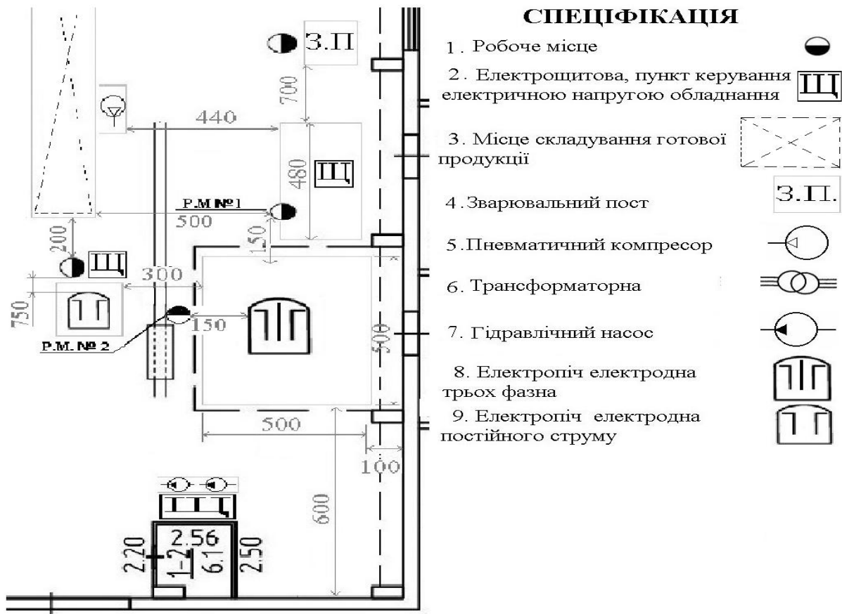
Рис. 2. План розташування робочих місць та технологічного, високотемпературного впливу обладнання у цеху: основна піч – РКО2-ПВ рудова кругла відкрита 3-х електродна, електродугова, W = 2 \text{ МВт} ; I = 12 \text{ кА} ; U = 45\text{--}90 \text{ В} постійного струму; лабораторна піч рудова кругла відкритого типу 1-но електродна електродугова, W = 150 \text{ кВт} ; I = 1,7 \text{ кА} ; U = 45\text{--}90 \text{ В} змінного струму; компресорні установки – 2 шт. V = 1600 \text{ л/год.} ; W = 7,5 \text{ кВт} ; Брикетувальний прес ПШ-350 – 15 \text{ кВт} ; зварювальний пост W = 12 \text{ кВт} ; Кран № 2 – 10 т
