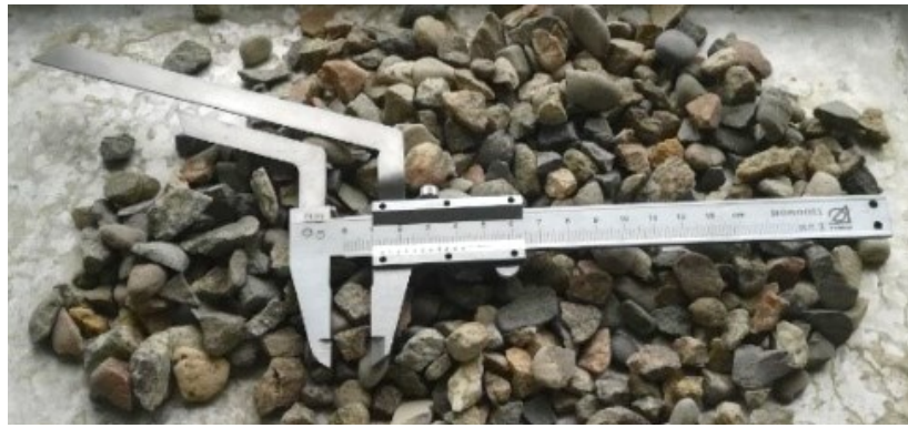
Рисунок 2.3. Шаблон для визначення вмісту зерен лещадної форми
