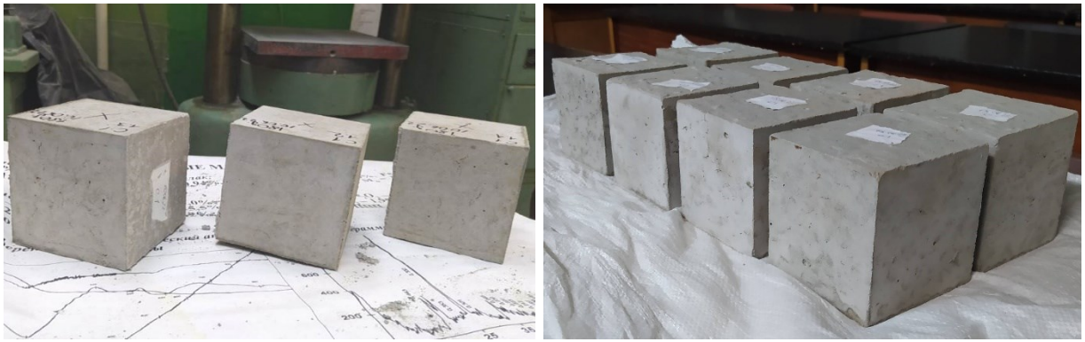
Рисунок 2.6. Готові до випробувань та подрібнення зразки бетону-джерела
