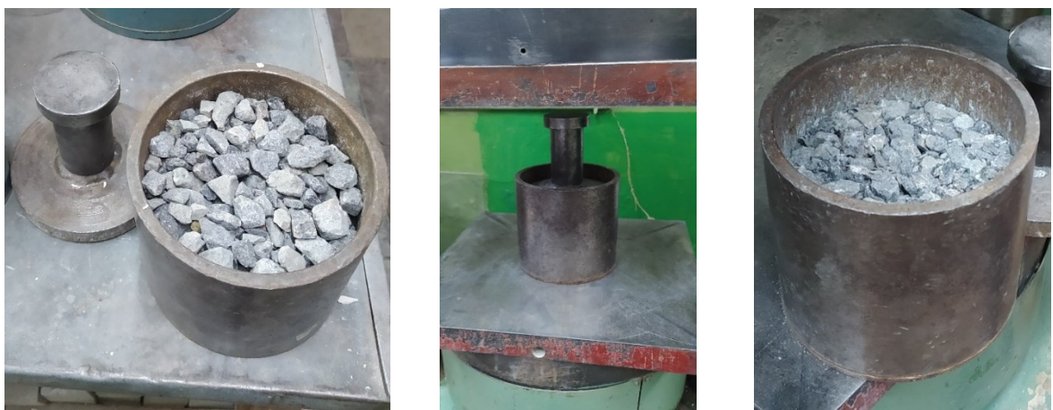
Рисунок 2.4. Процес випробування на дробильність в циліндрі діаметром 150 мм
