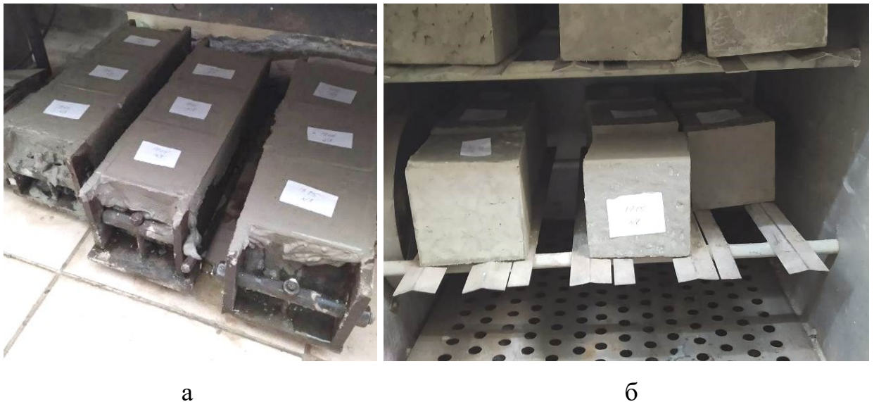
Рисунок 2.5. Зразки бетону-джерела: а – одразу після укладання суміші в форми; б – в сушильній шафі з постійними умовами
