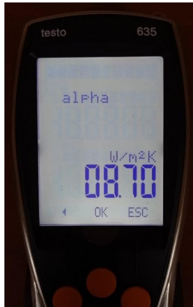
Рис. 5.19 Коефіцієнт теплопередачі огорожувальної конструкції
