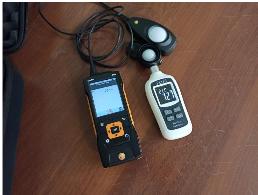
Рис. 2.10. Використані прилади для дослідження: зліва – Testo 440, справа – Flus MT-91
