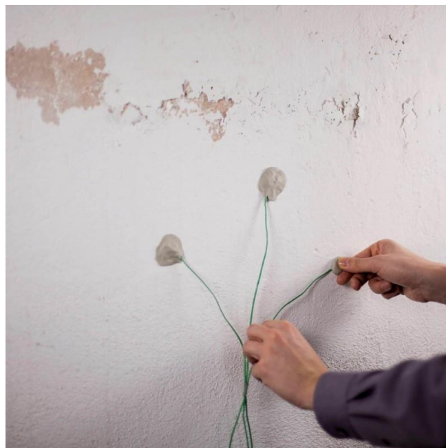
Рис. 5.16 Приклад закріплення 3-х фазного зонду
