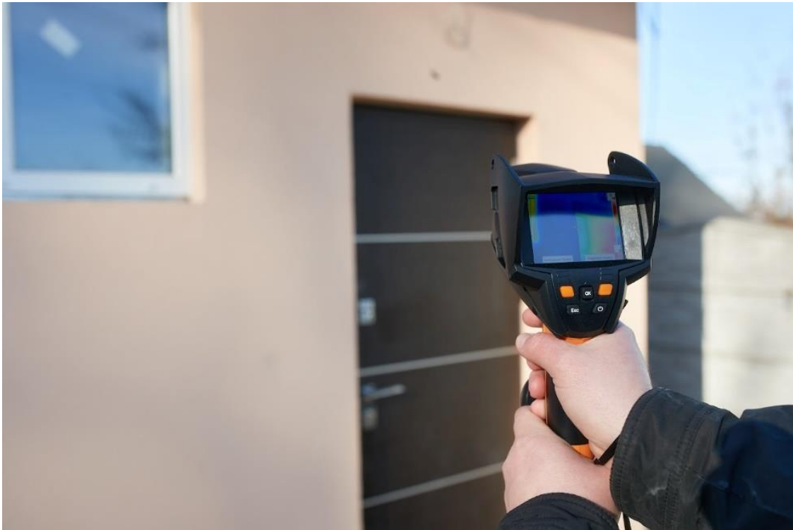
Рис.5.15 Застосування тепловізора для знаходження проблемних місць в утепленні будівлі
