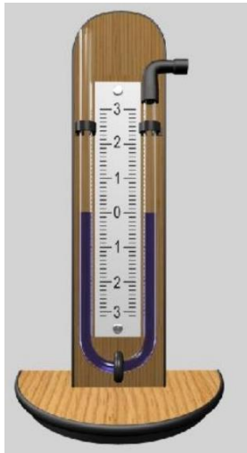
Рис. 4.6 Загальний вигляд рідинного манометра
