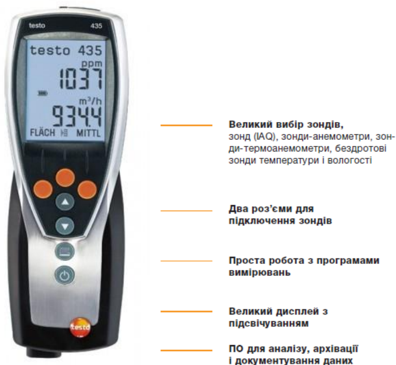
Рис. 4.18 Загальний вигляд багатофункціонального приладу Testo 435
