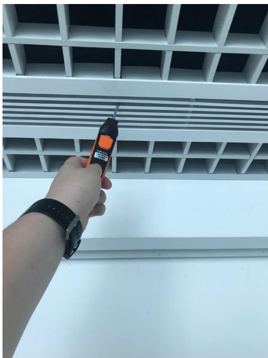
Рис. 4.27 Використання термометра Testo 915i для вимірювання температури речовин
