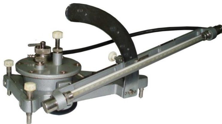
Рис. 4.10 Загальний вигляд мікроманометра
