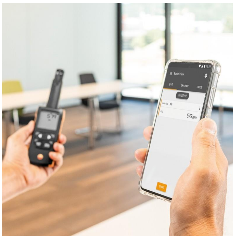
Рис. 1.6 Приклад використання Логгера Testo 535
