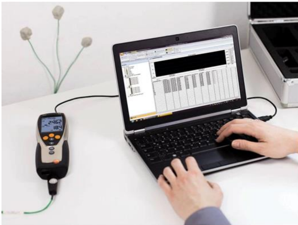
Рис. 5.23 Процес вимірювання коефіцієнта теплопровідності
