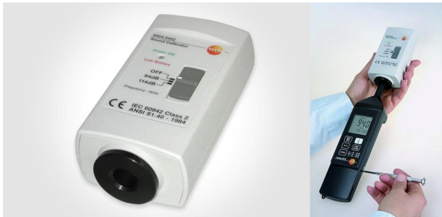
Рис 3.3 Калібратор рівня звуку для перевірки Testo 815 та процедура калібрування
