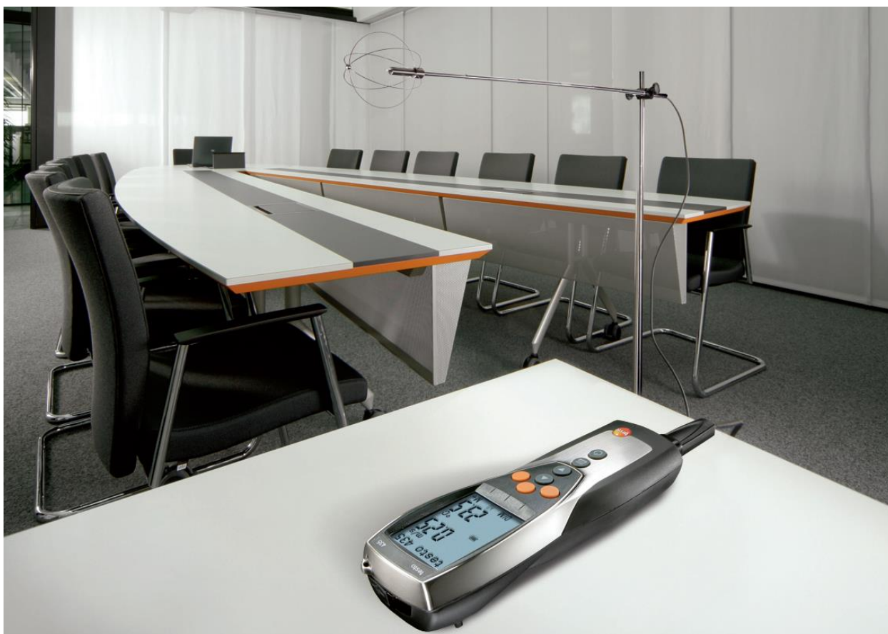
Рис. 4.25 Вимірювання комфорту приладом Testo 435
