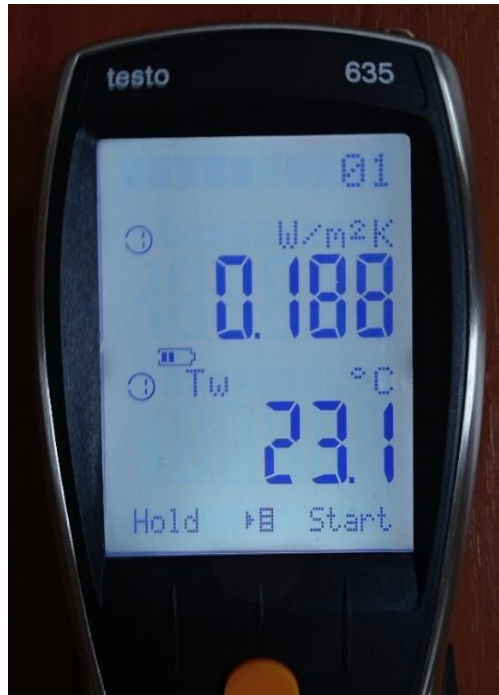
Рис. 5.21 Розрахунок приладом фактичного показника теплопровідності огорожувальної конструкції
