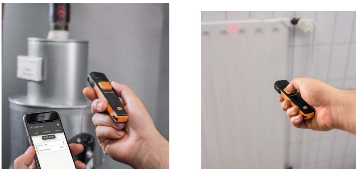
Рис. 4.30 Безконтактне вимірювання температури поверхні за допомогою міні пірометра Testo 805i
