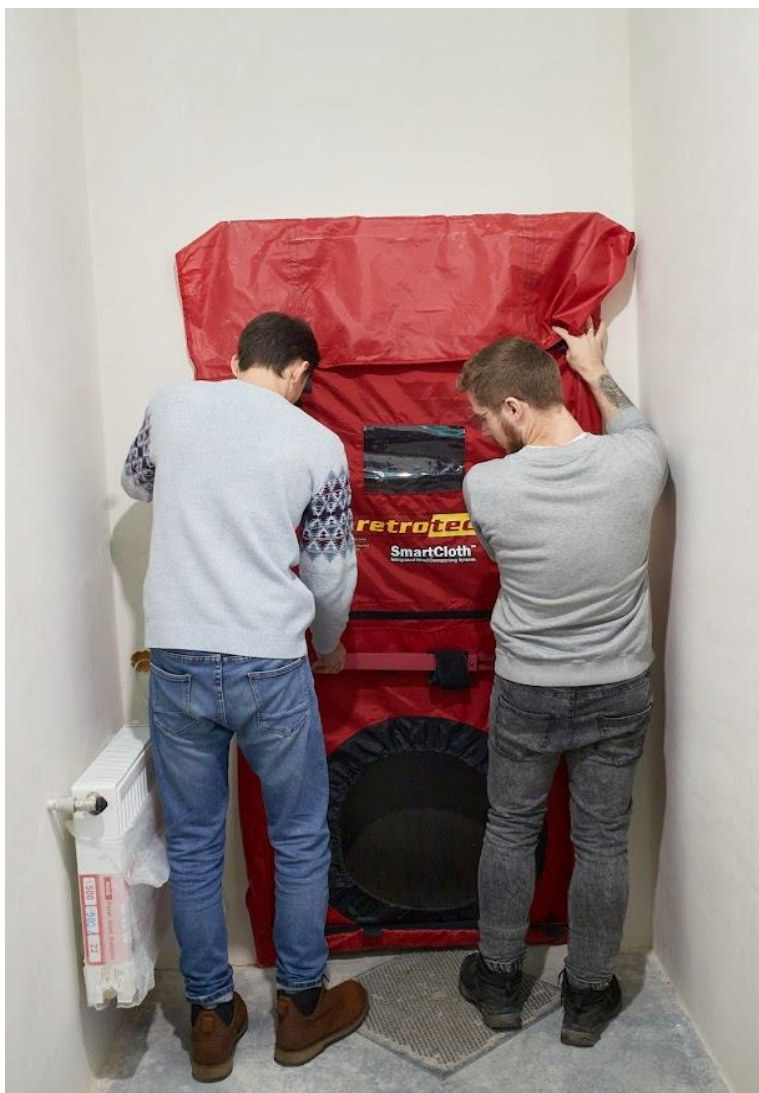
Рис.6.13 Встановлення аеродверей у вхідний проєм
