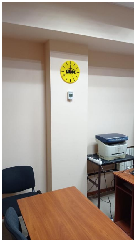
Рис.1.5 Прилад Testo 160 для вимірювання параметрів мікроклімату
