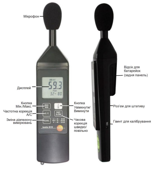
Рис. 3.2 Шумомір Testo 815
