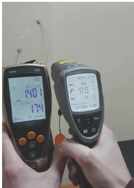
Рис. 5.18 Порівняння показників вимірювання пірометра та пристрою
