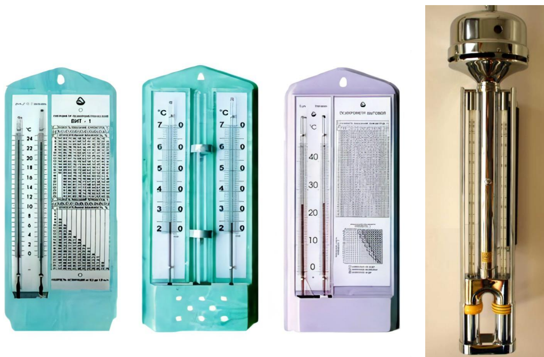
Рис. 4.15 Загальний вигляд психрометра
