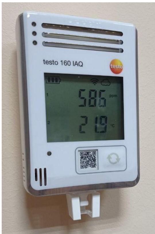
Рис.1.5 Прилад Testo 160 для вимірювання параметрів мікроклімату
