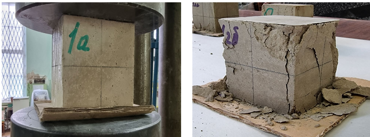
Рис. 2. Випробування зразків 70 \times 70 \times 70 мм, на пресі УММ-20
