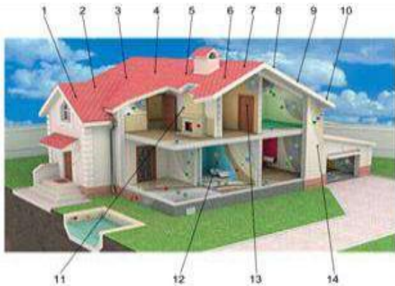
Рис. Вплив зовнішніх факторів на мікроклімат приміщень у процесі взаємодії з внутрішнім середовищем робочих місць: 1 – роза вітрів; 2 – інсоляція вдень; 3 – нічний час; 4 – дощ і вологість; 5 – хмарність; 6 – температура зимова; 7 – температура річна; 8 – швидкість вітру; 9 – матеріал будівельних конструкцій; 10 – стан поверхні зовнішнього боку будівельних конструкцій; 11 – температура всередині приміщення; 12 – оптимальна вологість усередині; 13 – подається кількість тепла всередину приміщення; 14 – теплова активність будівельних конструкцій [2]
