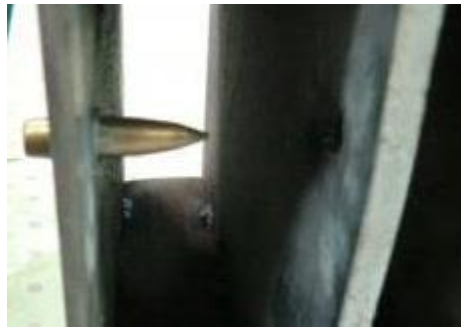
Рисунок 5.24 – Пробиття кулею сталевго листа
