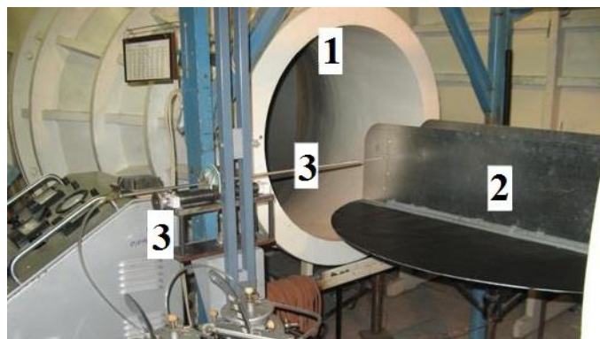
Рисунок 3.9 – Аеродинамічна труба Т5: 1 – аеродинамічна труба; 2 – експериментальна установка; 3 – вимірювальне обладнання
