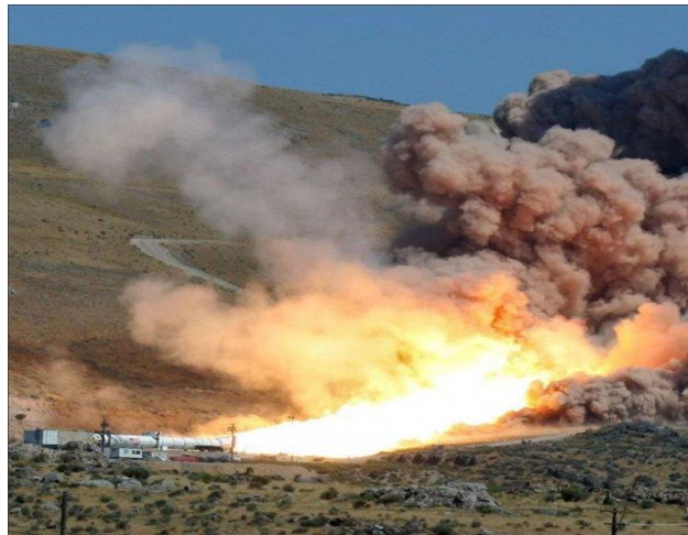
Рисунок 1.11 – Полігон NASA для випробування ракетних двигунів (добре видно інтенсивну зону забруднення атмосферного повітря продуктами горіння ТРП [ http://spynet.ru/blog/Interesting/39124.html ])
