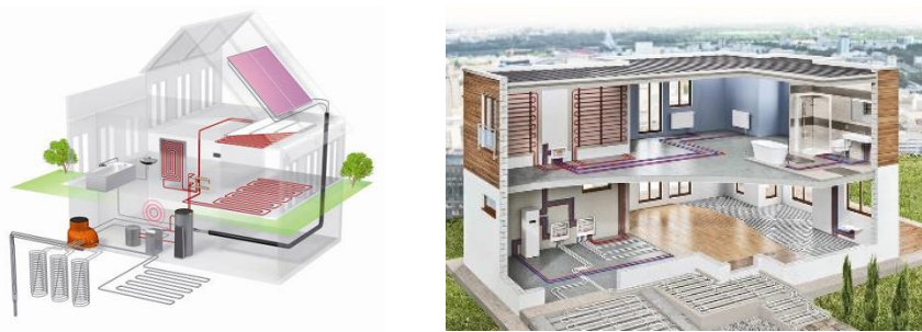
Рис. 2. Приклади низькотемпературних кліматичних інженерних систем
