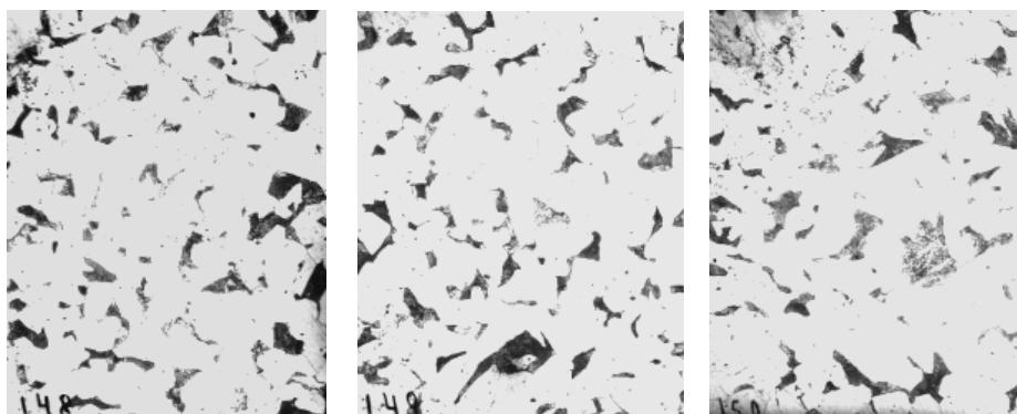
Рис. 2. Микроструктура стали Ст3пс, \times 500
