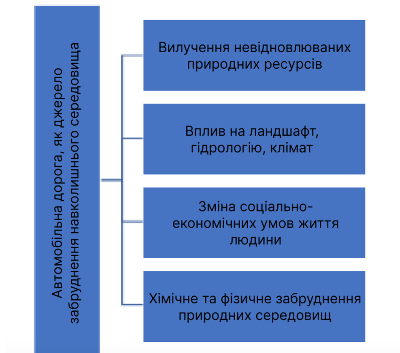
Рис.1.10. Автомобільна дорога - джерело забруднення навколишнього середовища [6]
