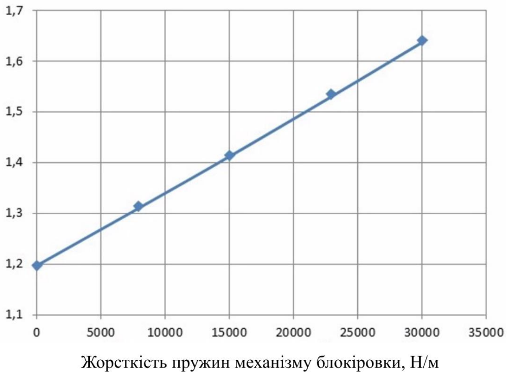
Рис. 3.18. Вплив жорсткості пружин механізму блокування на переміщення штока-вимикача наприкінці першої ділянки
