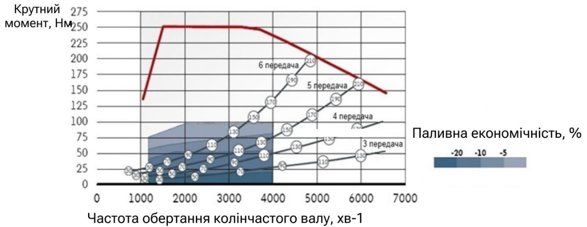
Рис. 1.17. Експлуатаційні можливості системи відключення циліндрів ZAS
