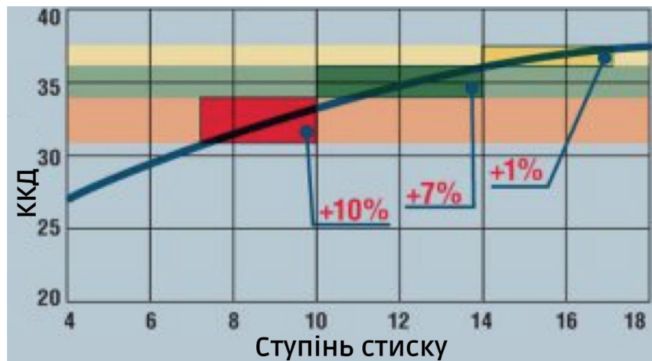
Рис. 1.1. Залежність ККД двигуна від ступеня стиску
