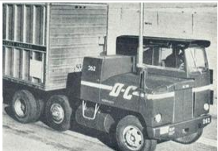
Рис. 170 – Спальник збоку кабіни вантажівки «Kenworth» (1954 р.)
