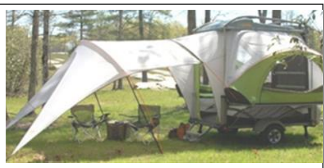
Рис. 299 – Комбінована конструкція, що складається із кузова трейлера та додаткового розкладного тенту
