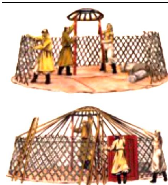
Рис. 111 – Загальна послідовність спорудження юрти: установка канів, верхнього кільця та жердин куполу
