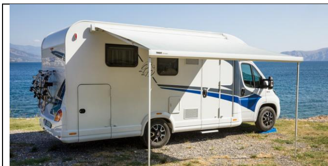
Рис. 298 – Комбінована конструкція, що складається із кузова кемперу та розкладного тентового навісу-маркізи
