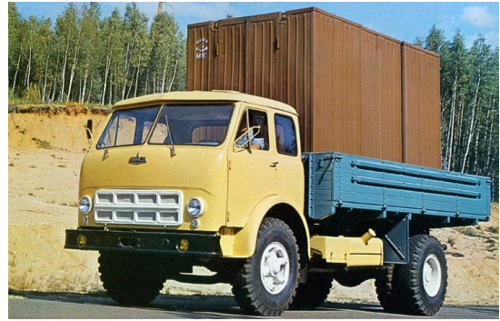
Рис. 172 – МАЗ-500 Кабіна із інтегральним спальним відсіком (1960-і рр.)
