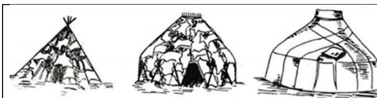
Рис. 103 – Схематичне зображення конструктивно-формотворчої еволюції юрти
