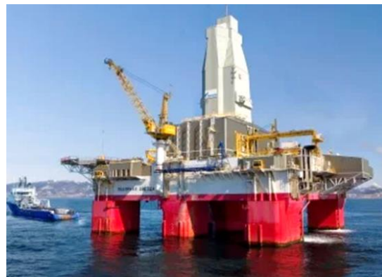
Рис. 312 – Плавуча напівзанурена бурова платформа катамаранного типу «Полярна зірка» (Сахалінський шельф, Охотське море, Росія, 2016 р.)
