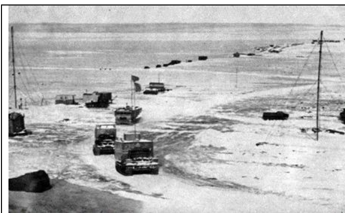
Рис. 179 – Перевезення всюдиходами «Пінгвін» саних вахтових будинків на полярну антарктичну станцію «Піонерська» (1957 р.)
