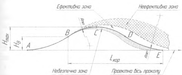
Рис. 3. Зоны эффективности траектории прокола почвы
