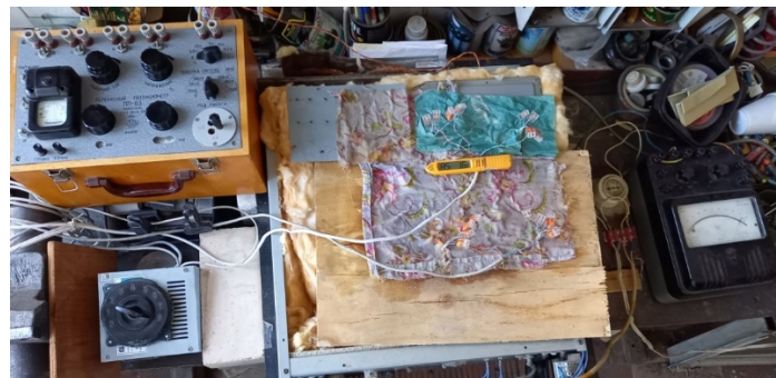
Рис. 10.6. Прилади вимірювання температури каменю та камера з досліджуваним камінням та виведеними кінцями приєднання термопар
