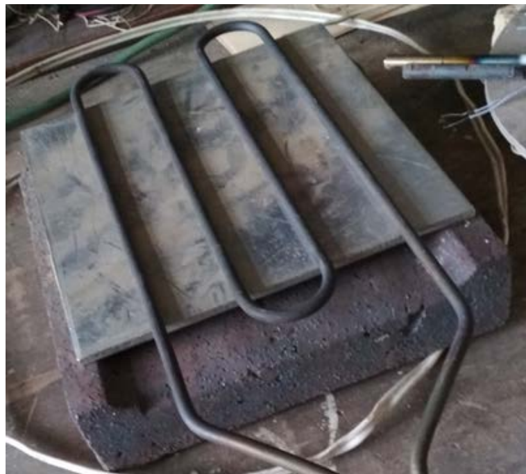
Рис. 10.14. Співвідношення розміру алюмінієвої пластини та досліджуваного каменю
