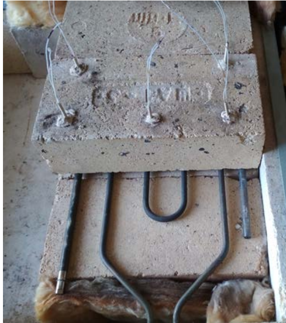
Рис. 10.7. Розміщення шамотного каменю, що досліджується, з термопарами на тені
