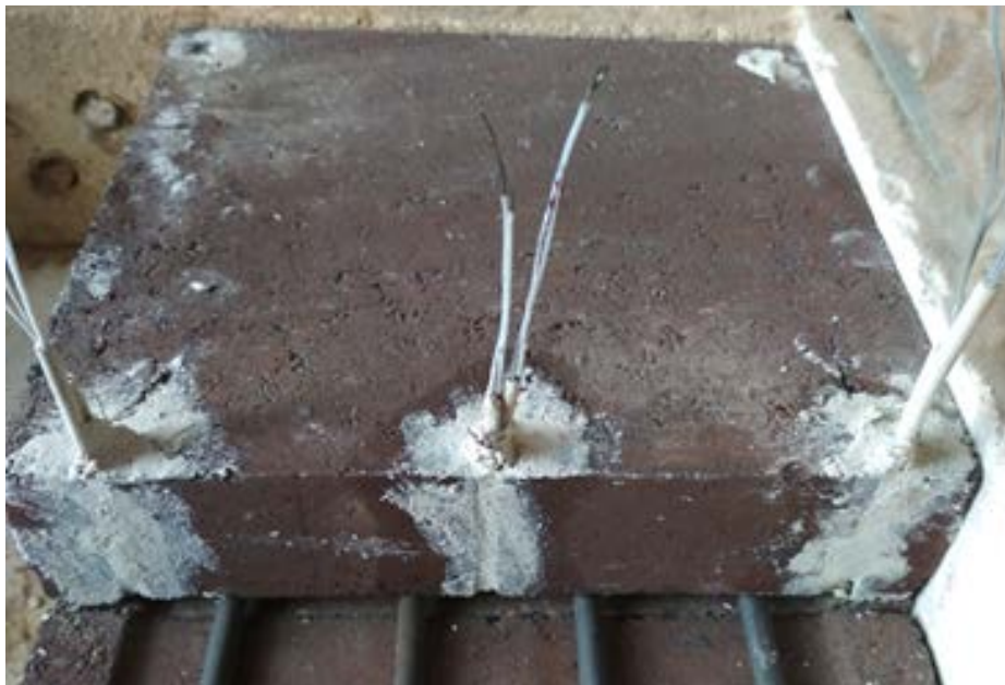
Рис. 10.11. Розміщення теплоаккумуляційного каменю на тен в камері нагрівання
