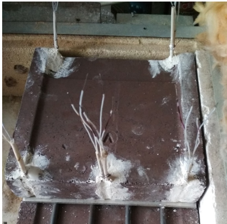
Рис. 10.15. Розміщення досліджуваного каменю на алюмінієвій пластині камери нагріву
