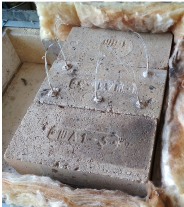
Рис. 10.8. Розміщення шамотного каменю, що досліджується, з термопарами в камері нагріву
