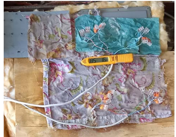
Рис. 10.18. Накриття теплоізоляції кришкою із фанери з вологою тканиною
