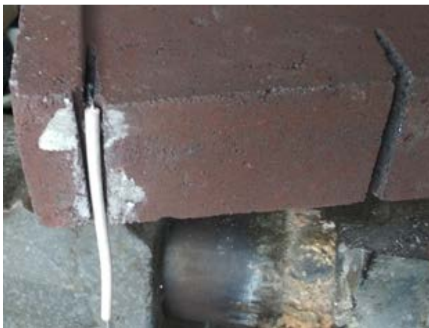
Рис. 10.12. Розміщення термоелектричного перетворювача в теплоаккумуляційному камені з теплоакumuлюючому нагрівачі Technotherm ТТВ 17
