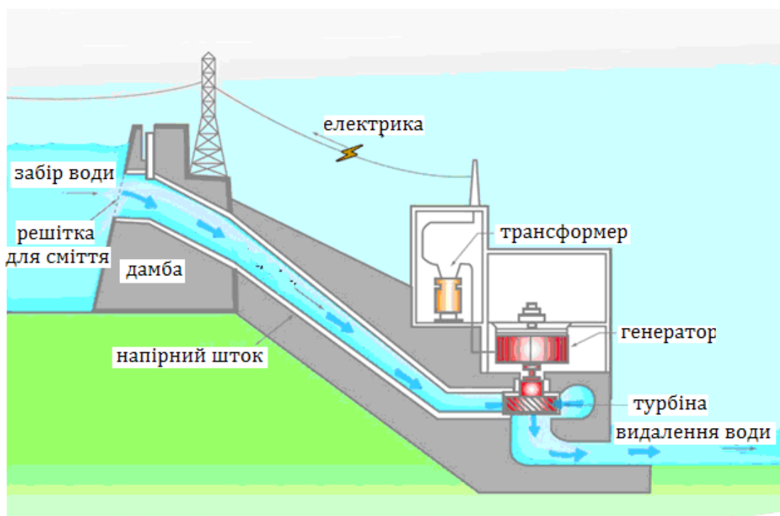
Рис.1.2. Як працює гідроелектростанція [3]
