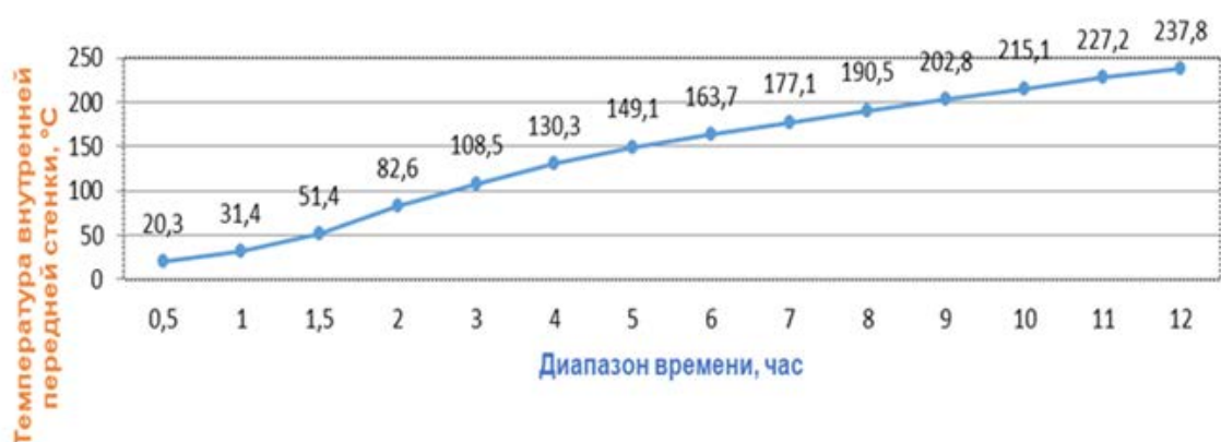
Рис. 7.11. Графік температури внутрішньої передньої стінки теплоаккумулятора (термопара №11)
