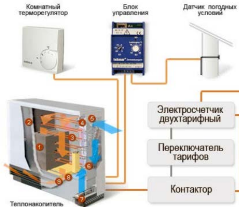
Рис. 5.8. Система опалення з акумулятором тепла і структура тепло накопичувача (теплоакумулятора): 1 – магнетитові блоки; 2 – шар теплоізоляції; 3 – нагрівальні елементи; 4 – ручка терморегулятора; 5 – терморегулятор; 6 – вузол підключення; 7 – вентилятор; 8 – заслінка; 9 – біметалічний датчик
