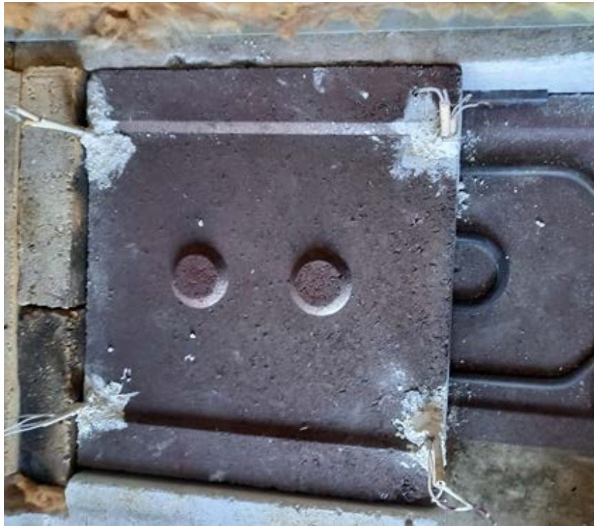
Рис. 10.13. Розміщення досліджуваного теплоаккумуляційного каменю з теплоакumuлюючого нагрівача Elnur ADS 168 на тенах в камері нагрівання
