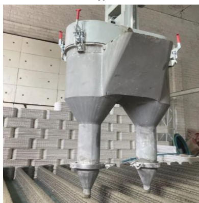
Рис. 7. Будівельні принтери конструкції ПДАБА: а, б – загальний вигляд; в – екструдер із двома соплами; г – вироби.
