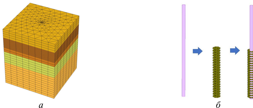
Рис. 1. Геометрична скінченно-елементна модель: а) ґрунтової основи; б) багатовиткової палі
