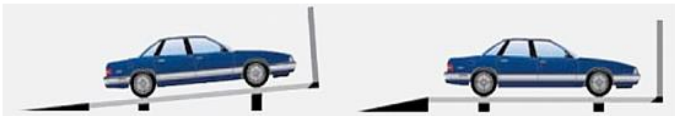
Рис. 4.2. Зображення встановлення автомобіля на стапелі
