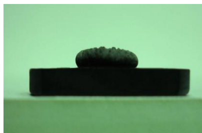
Рис.1. Крапля зі сплаву на основі магнію після кристалізації на графітовій підкладці
