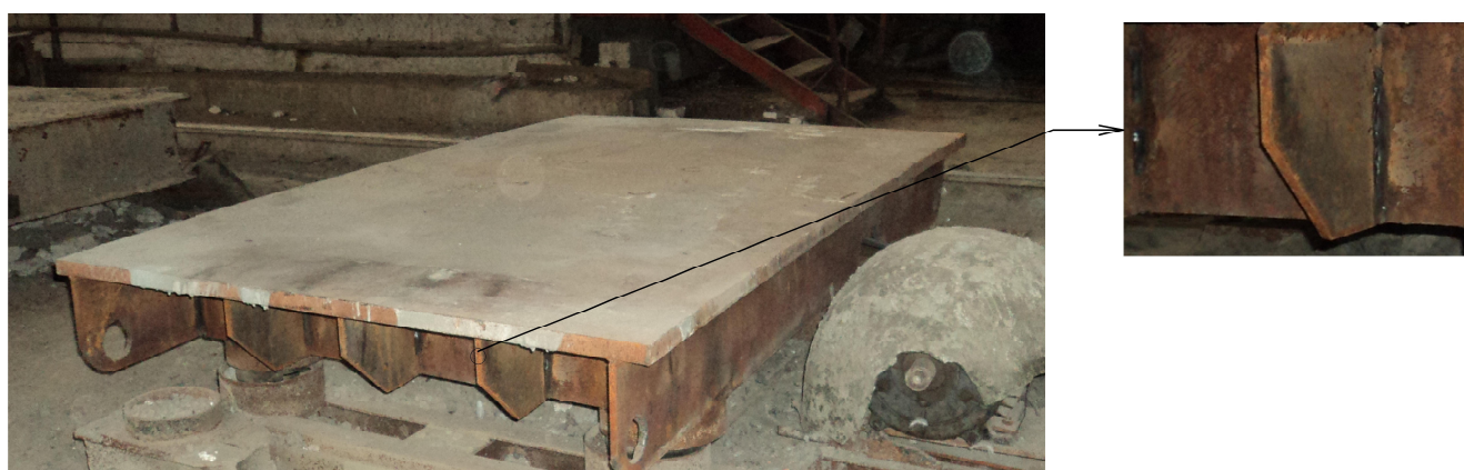
Рис. 2.3. Общий вид опытного виброагрегата без нанесения вибродемпирующего покрытия
