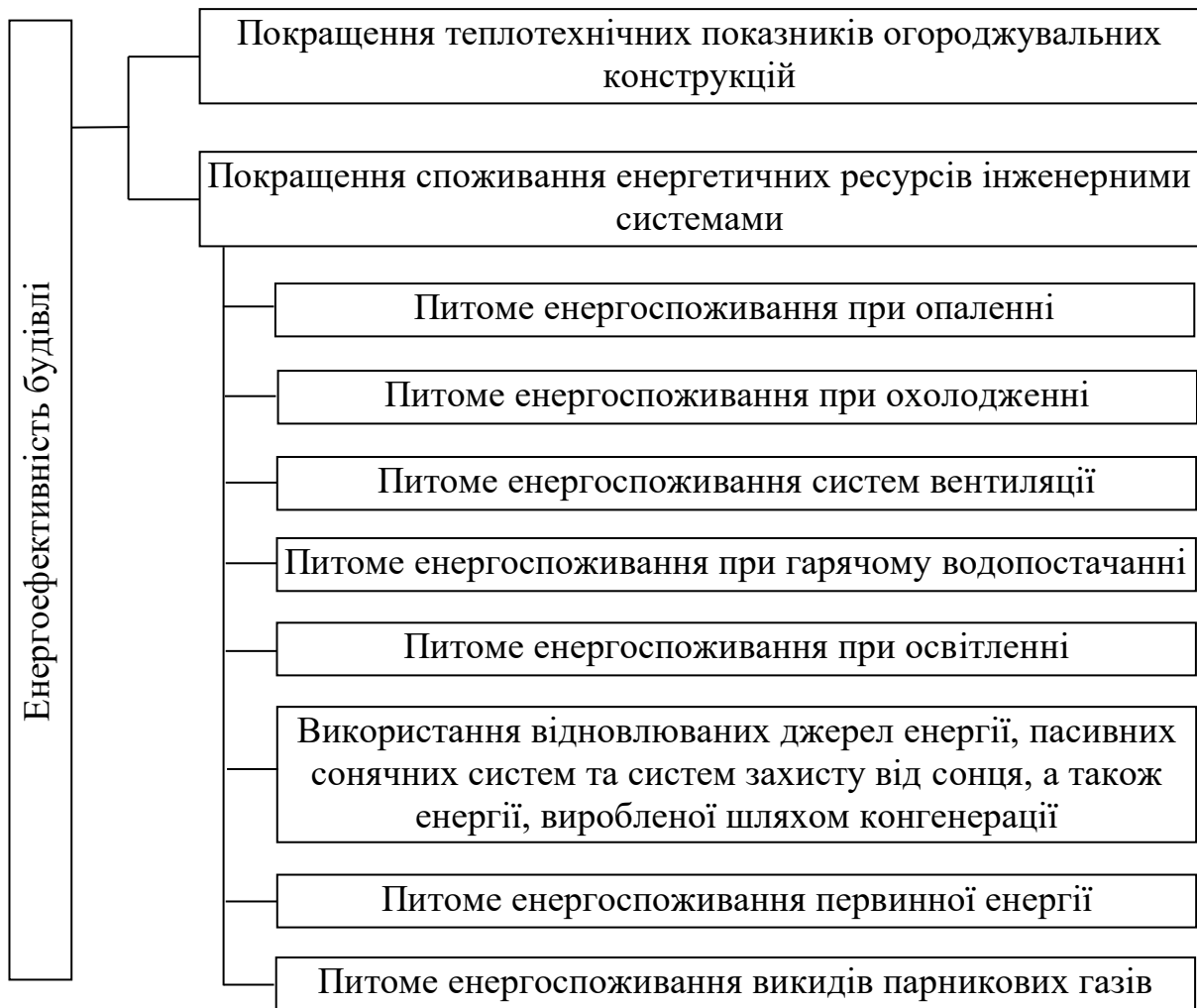
Рисунок 4 – Складові фактора енергоефективності будівлі
