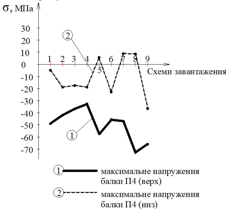
Рисунок 6 – Графік максимальних напружень в поперечній балці П4
