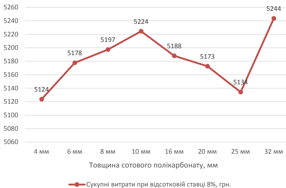
Рисунок Б.4 – Залежність сукупної вартості життєвого циклу 1 кв. м теплиці від товщини полікарбонату з урахуванням дисконтування із ставкою 8%
