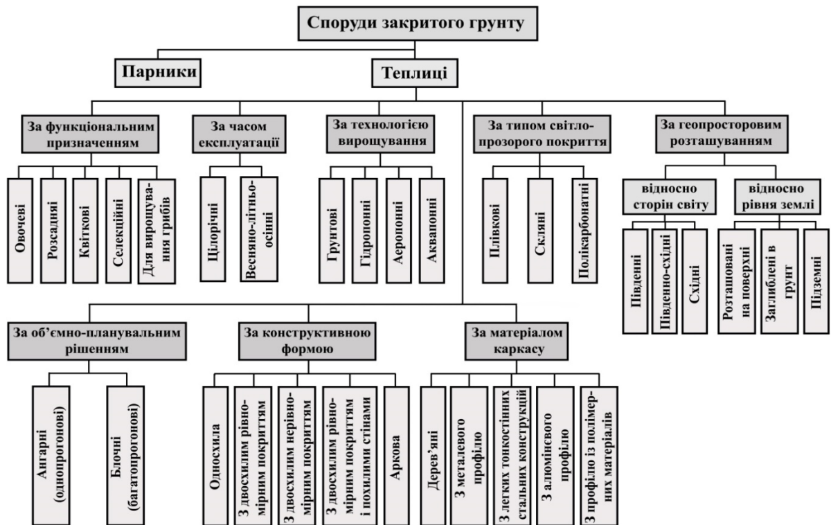
Рисунок 1.6 – Класифікація споруд закритого ґрунту (класифікація автора)
