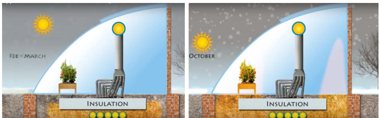
Рисунок 1.8 – Система обігріву канадської геліотеплиці «Groundswell»
