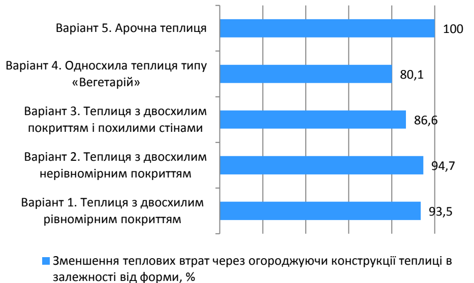
Рисунок 3.10 – Теплові втрати через огороджуючі конструкції теплиць в залежності від форми теплиці у відсотках (%)
