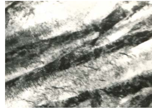
Рис. 1. Структура сталі 45 після гартування і відпуску при температурі 300 °С. Збільшення \times 16\,000
