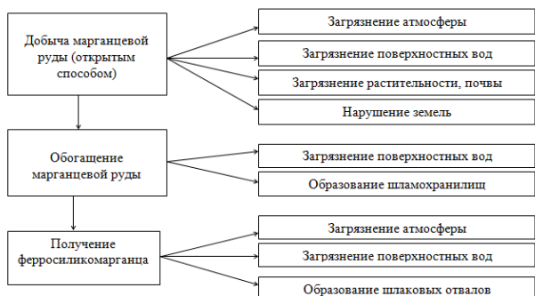
Рис. 1. Влияние производства ферросплавов на ОС / Fig. 1. The influence of ferroalloy production has on the environment
