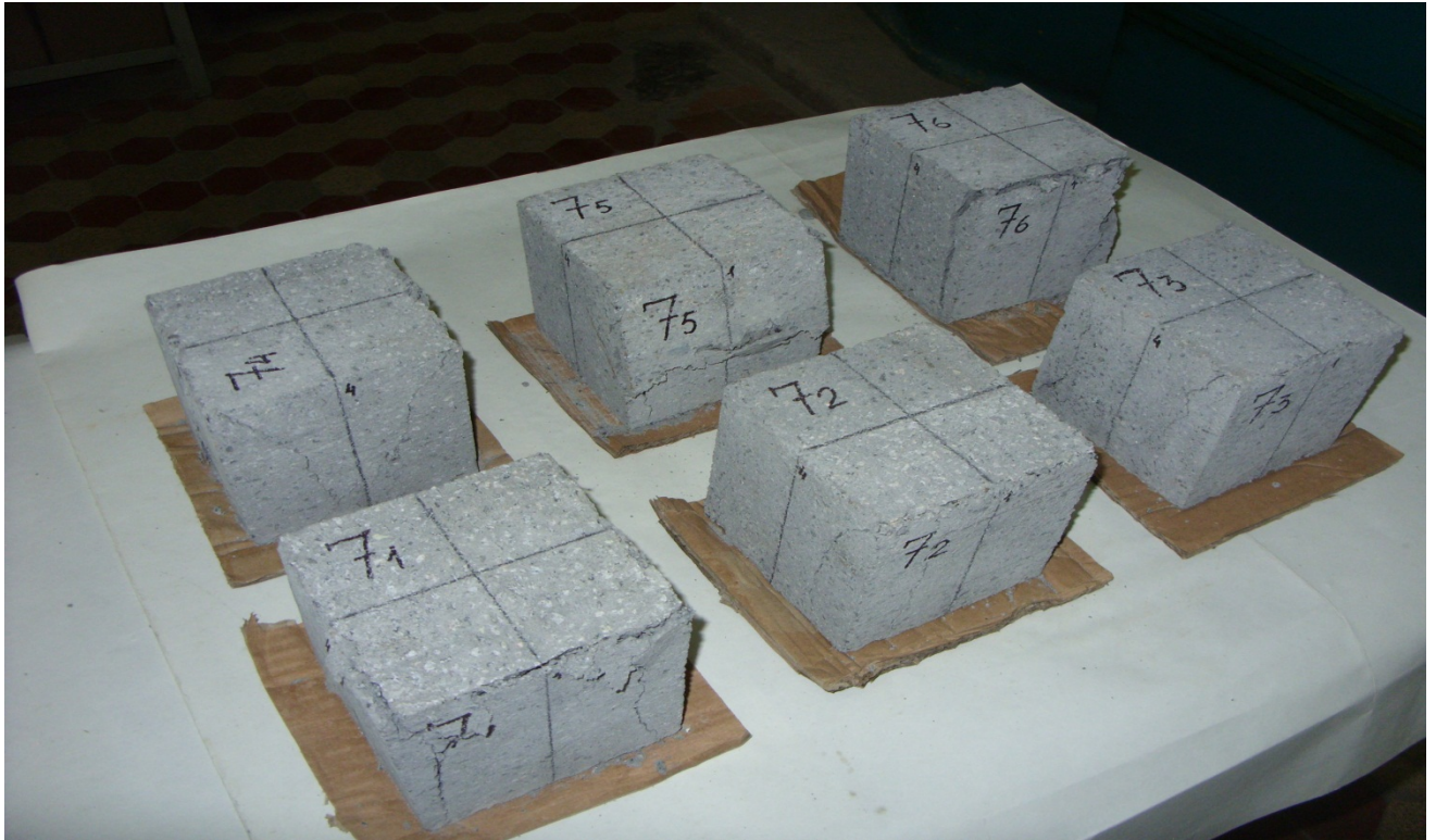
Рис. 2.31. Загальний вигляд бетонних зразків після руйнування.
