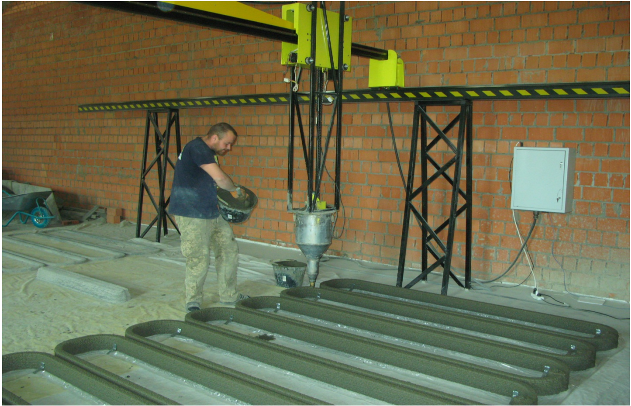
Рис. 2.15. Загальний вигляд 3D принтеру при виготовленні секцій огороження
