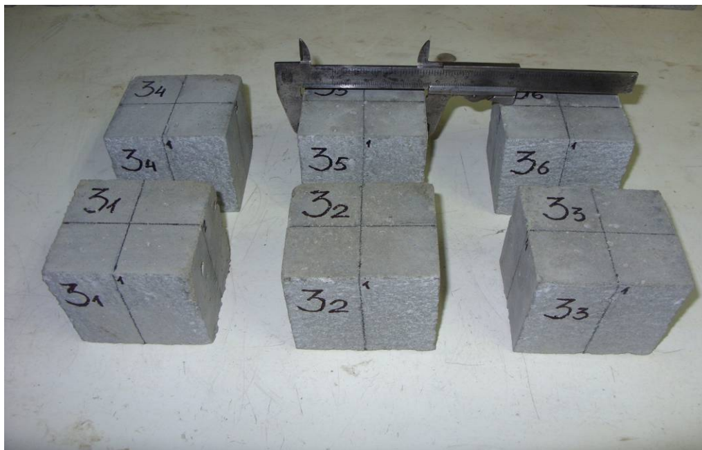
Рис. 2.22. Вимірювання лінійних розмірів зразків
