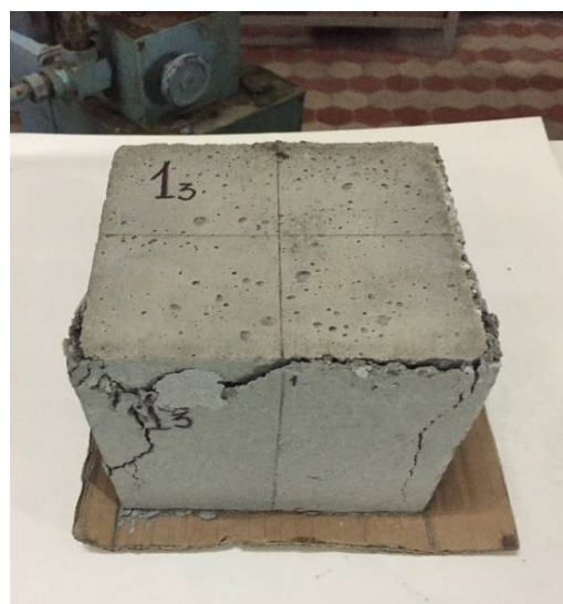
Рис. 2.26. Структура внутрішньої поверхні і характер руйнування зразків розмірами 150 x 150 x 150мм
