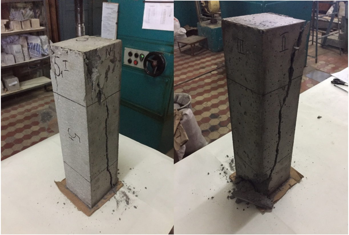
Рис 2.48. Характер руйнування бетонної призми П-5 1
