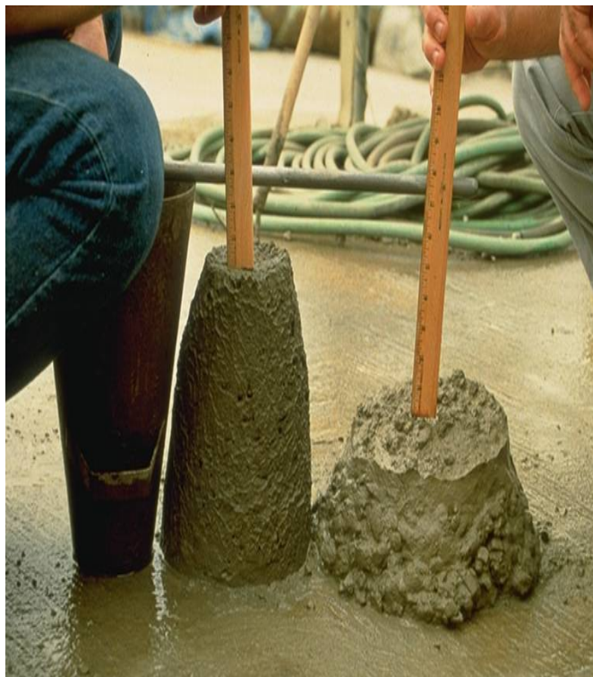
Рис. 2.3. Вплив зольного пилу на консистенцію бетону
