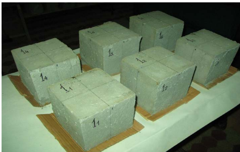
Рис. 2.25. Загальний вигляд бетонних зразків номінальним розміром ребра 150 мм після руйнування
