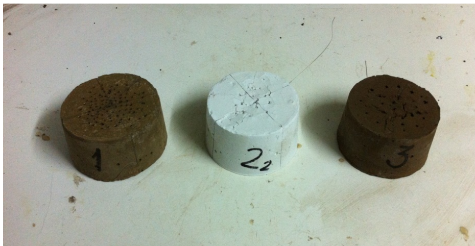
Рис. 2.11. Загальний вигляд зразків композицій 1-3 після визначення терміну схвачування
