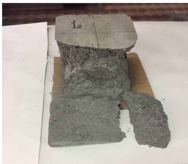
Рис. 2.26. Структура внутрішньої поверхні і характер руйнування зразків розмірами 150 x 150 x 150мм
