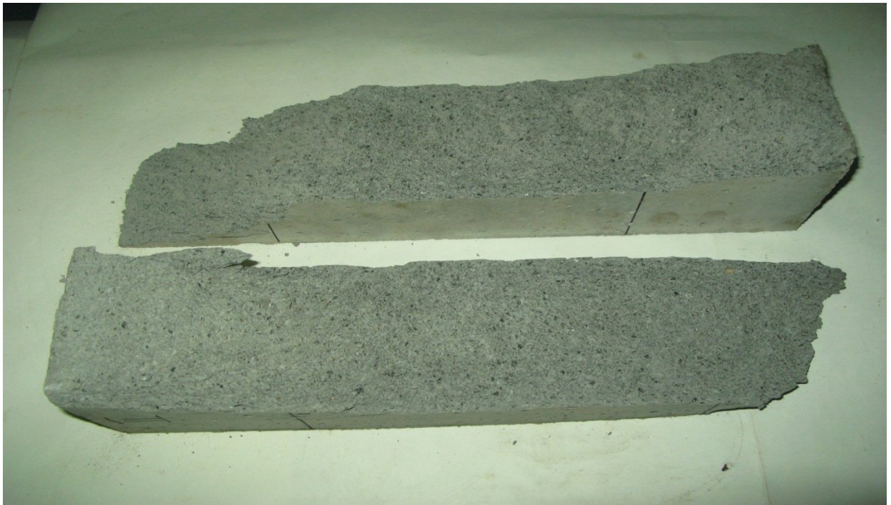
Рис. 2.49. Структура внутрішньої поверхні бетону призми після розколювання
