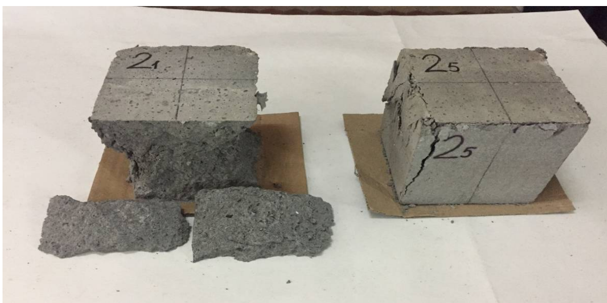
Рис. 2.30. Структура внутрішньої поверхні і характер руйнування зразків, номінальними розмірами 100 x 100 x 100 мм, виготовлених за традиційною технологією
