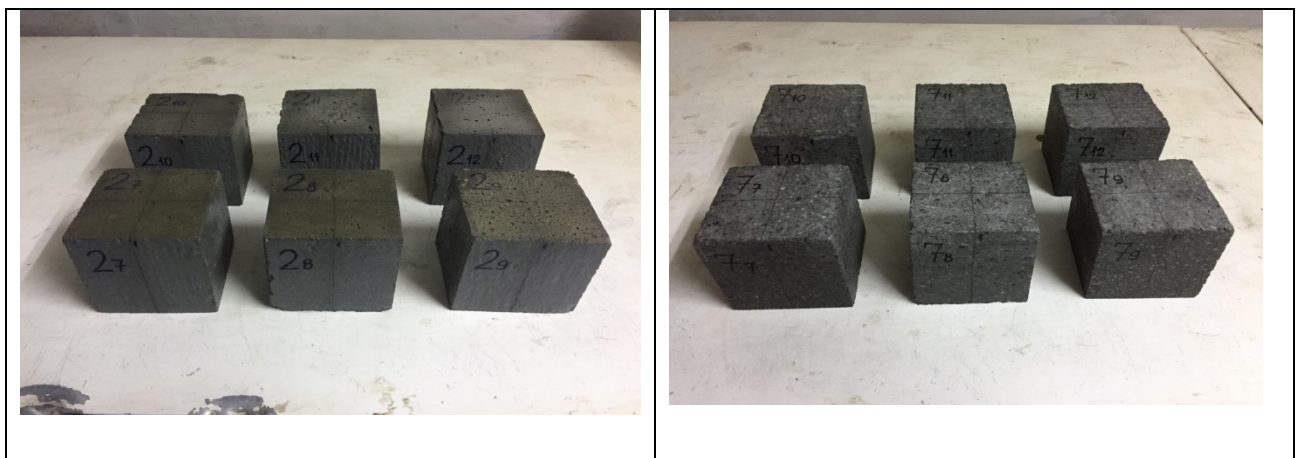
Рис. 2.24. Загальний вигляд бетонних зразків після взаємодії з водою
