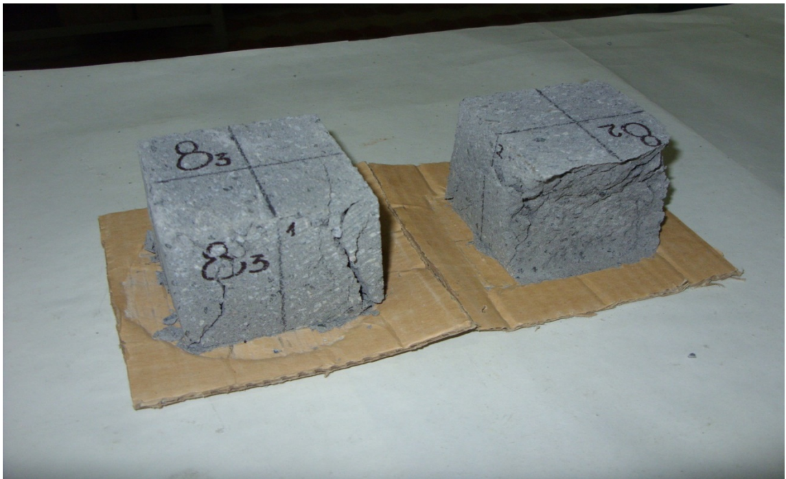
Рис. 2.36. Характер руйнування зразків номінальними розмірами 70 x 70 x 70мм і структура внутрішньої поверхні бетону
