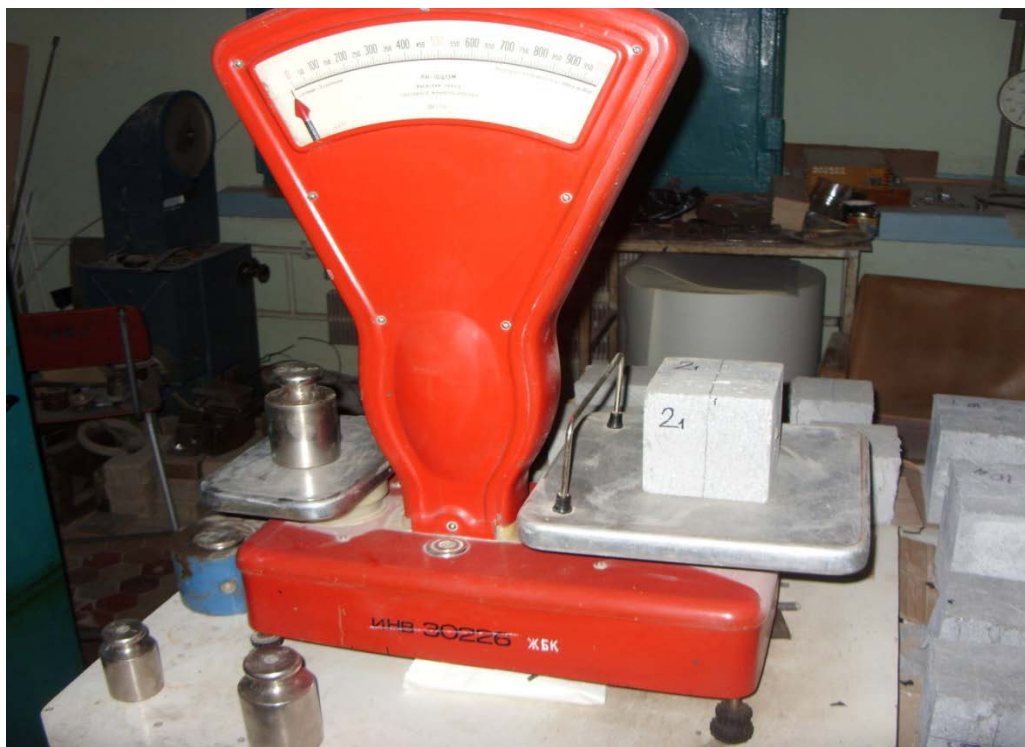
Рис. 2.21. Зважування зразків бетону для визначення їх об'ємної маси
