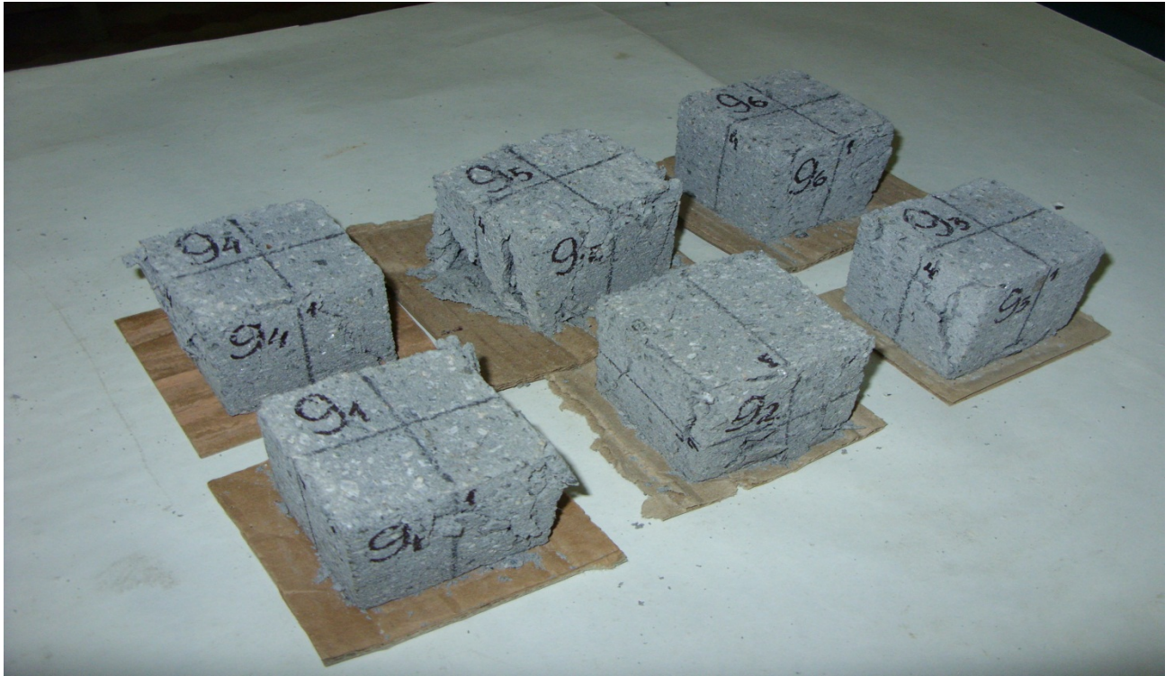
Рис 2.39. Загальний вигляд бетонних зразків після руйнування
