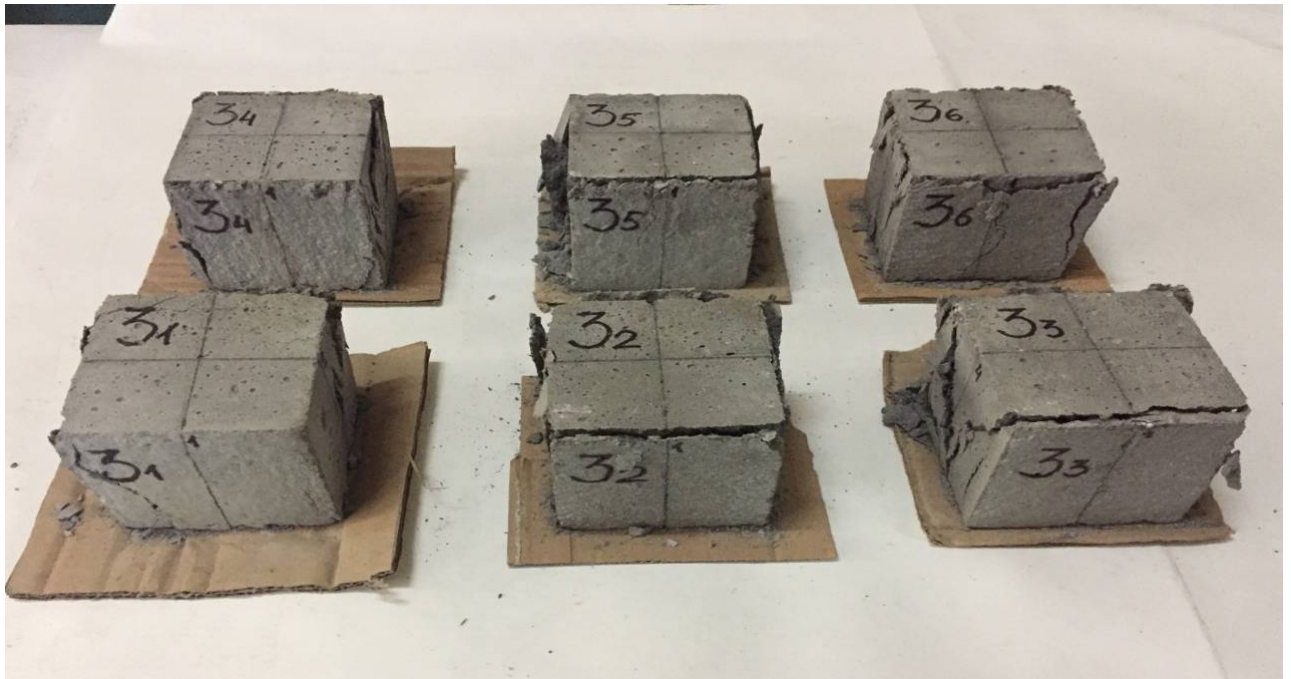
Рис. 2.33. Загальний вигляд бетонних зразків після руйнування
