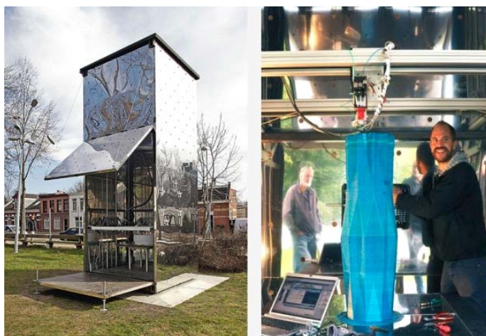
Рис. 1.16. Будівельний 3D - принтер KamerMaker (RoomBuilder).
