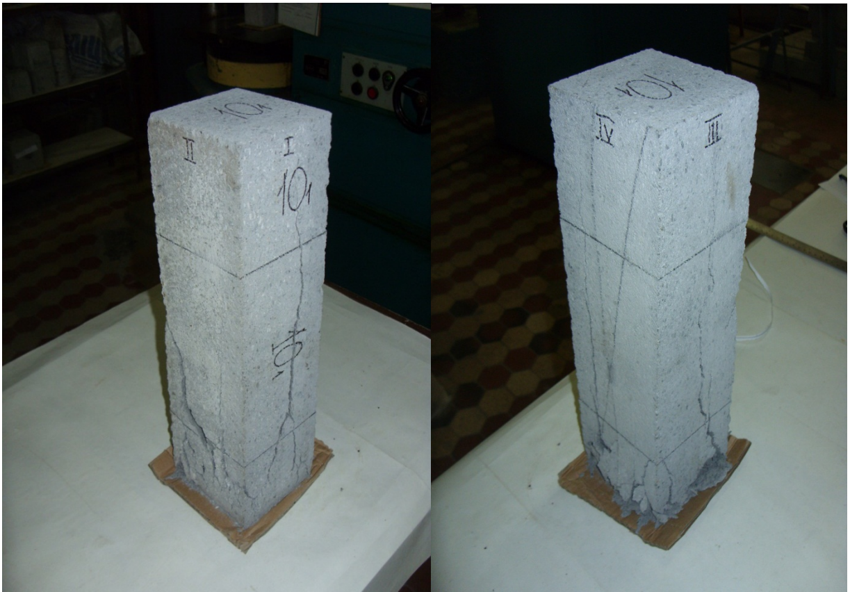
Рис. 2.51. Характер руйнування бетонної призми П-10 1 по гранях I-II і III-IV відповідно
