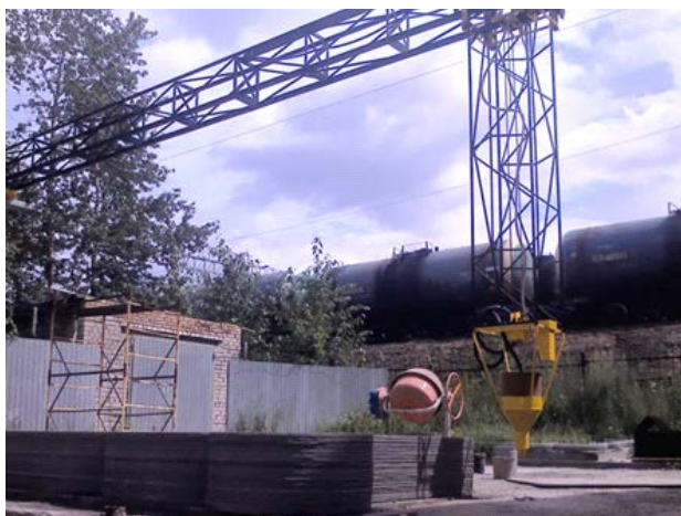
Рис. 1.14. Будівельні 3D принтери тривимірного друку S-1160, що встановлені: а) на будівельному майданчику; б) в цеху.
