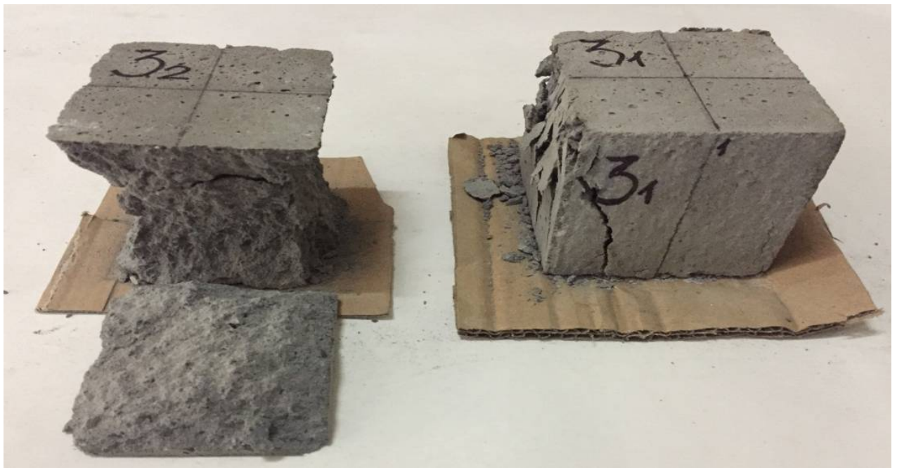
Рис. 2.34. Структура внутрішньої поверхні і характер руйнування зразків номінальними розмірами 70 x 70 x 70мм
