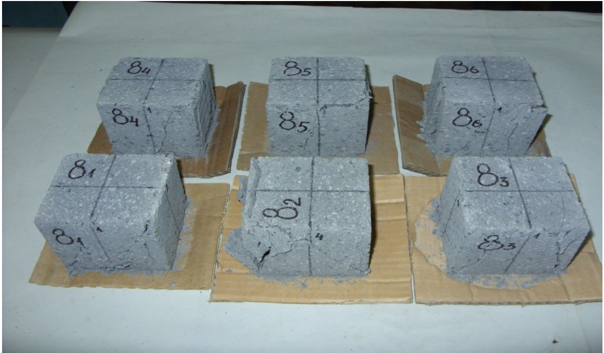
Рис 2.35. Загальний вигляд бетонних зразків після руйнування
