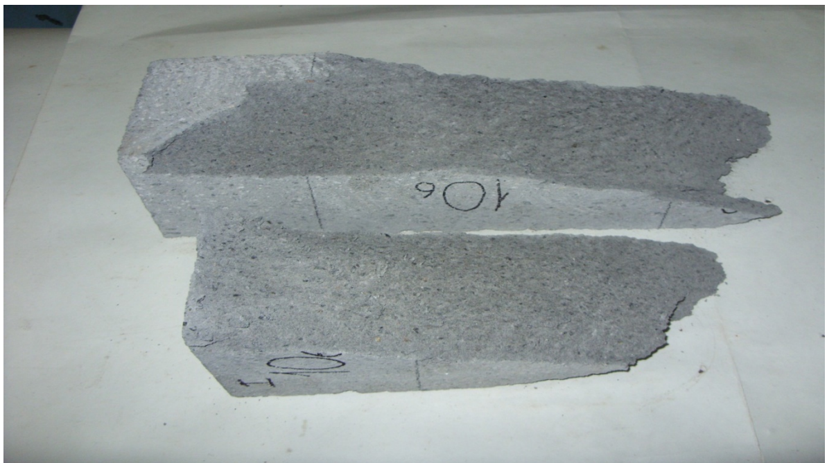
Рис. 2.52. Структура внутрішньої поверхні бетону призми, відібраної з конструкції
