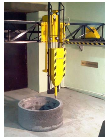
Рис. 1.14. Будівельні 3D принтери тривимірного друку S-1160, що встановлені: а) на будівельному майданчику; б) в цеху.
