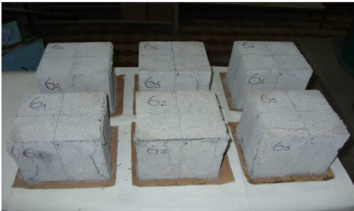
Рис. 2.27. Загальний вигляд бетонних зразків складу 6 після руйнування
