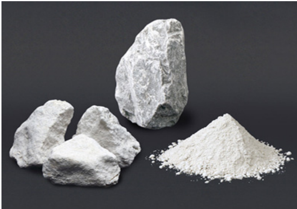
Рис. 2.5. Типи вапнякового наповнювача
