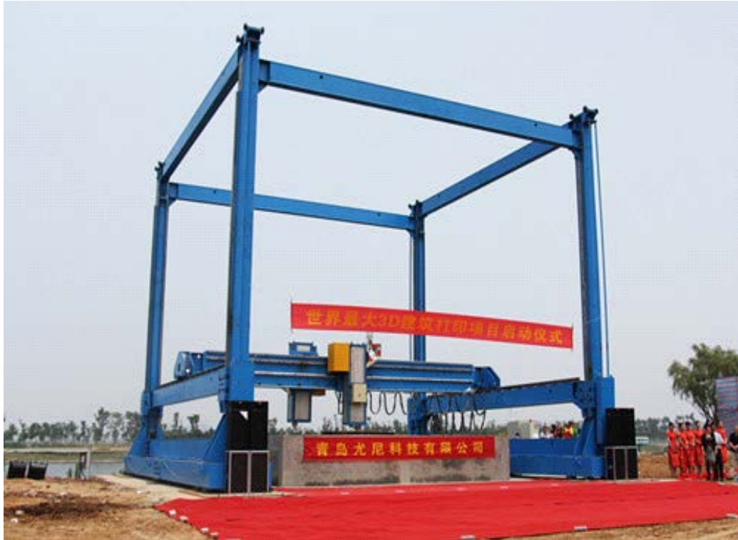
Рис. 1.18. Будівельний 3D - принтер в Циндао.
